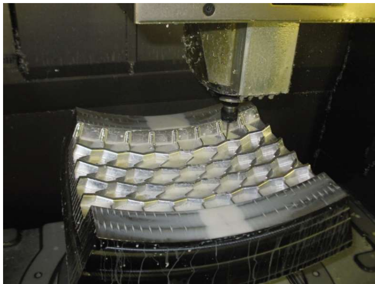
Figura 17 - Maquinação CNC de um módulo de um molde segmentado [36]
