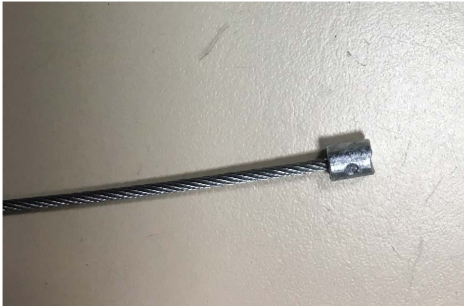
Figura 9 - Cabo de comando após corte de gitos
