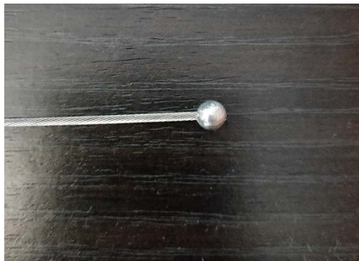
Figura 6 - Cabo após ter sido injetado um terminal em Zamak
