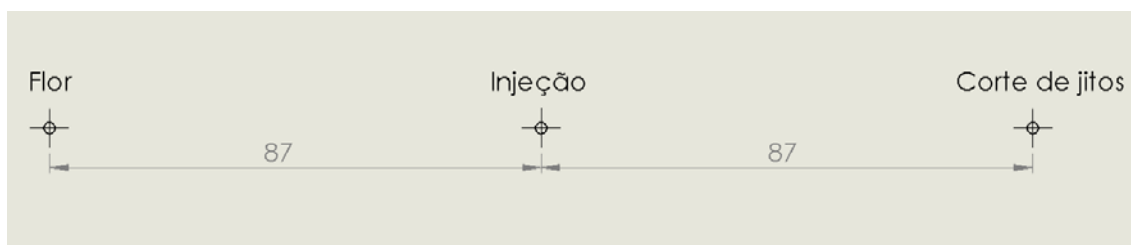
Figura 66 – Distâncias (em mm) entre as três fases do processo de injeção de Zamak
