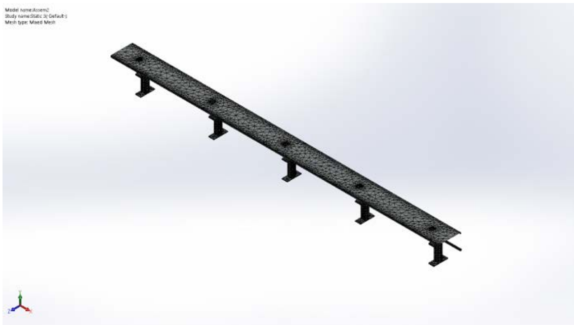
Figura 82 - Aspeto da malha utilizada para o cálculo do sistema de seleção
