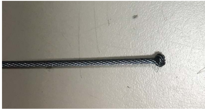
Figura 7 - Cabo de comando após a realização da flor
