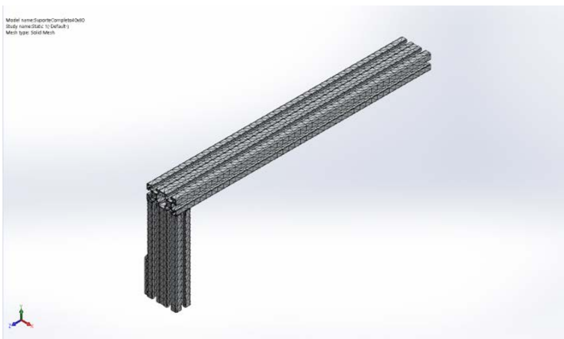
Figura 76 - Aspeto da malha utilizada para o cálculo da análise dinâmica
