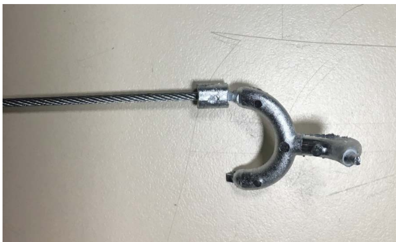
Figura 8 - Cabo de comando após ser feita a injeção
