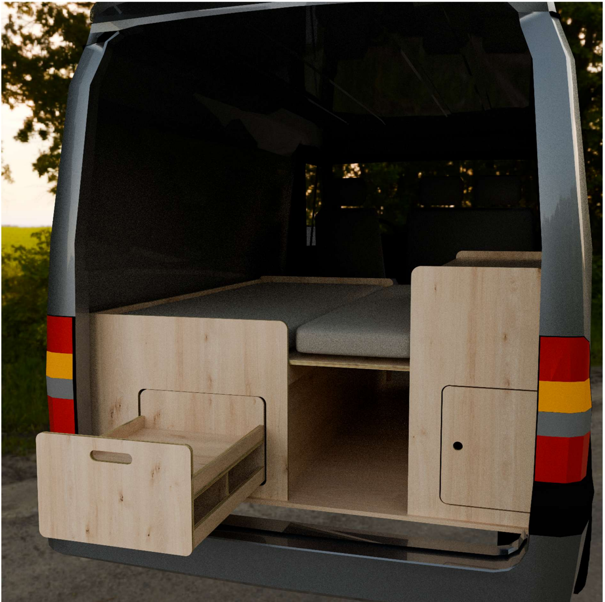
Figura 56- Renderização de vista traseira onde se pode ver a cama expandida e a cozinha exterior, com espaço para arrumação do campingaz e acessórios Fonte: Renderização do autor
