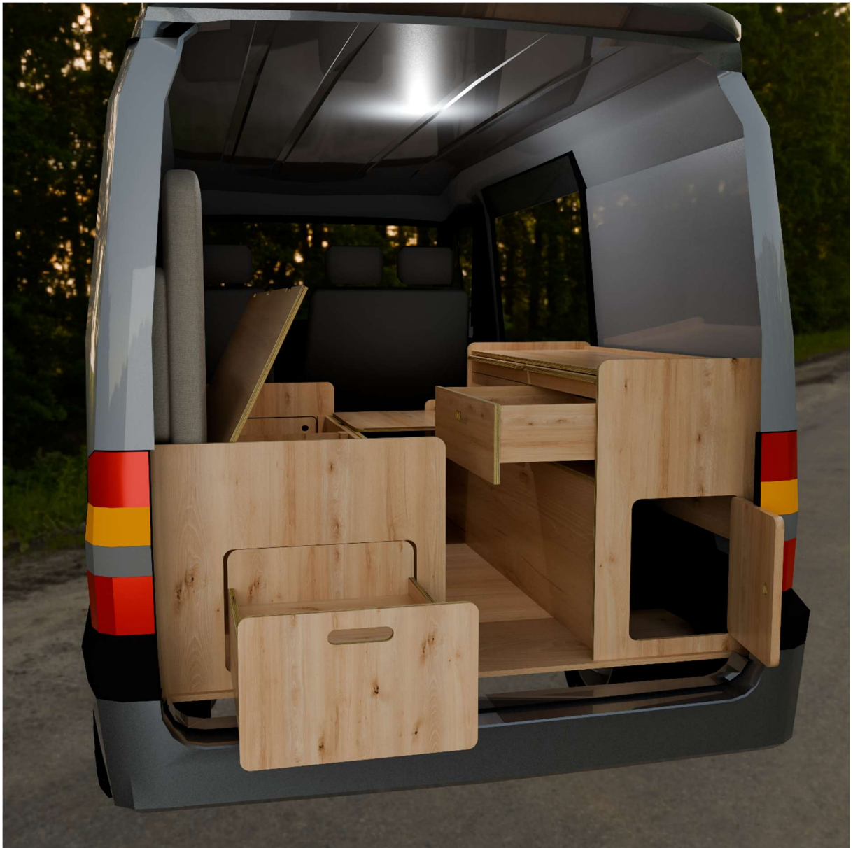
Figura 60- Renderização de vista traseira onde se pode observar muitas das funcionalidades do módulo em simultâneo, como o espaço de armazenamento aberto á direita com acesso traseiro para objetos mais compridos Fonte: Renderização do autor
