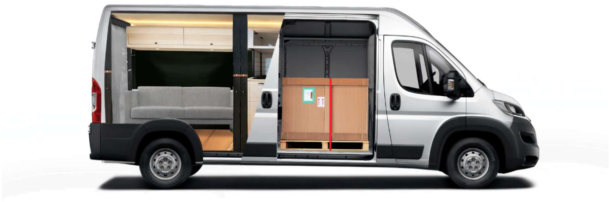
Figura 7- Vista de corte de módulos Van Cubic ainda com espaço de carga disponível Fonte: https://vancubic.com
