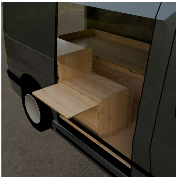
Figura 27- Mesa extensível para o exterior da carrinha Fonte: Imagem do autor
