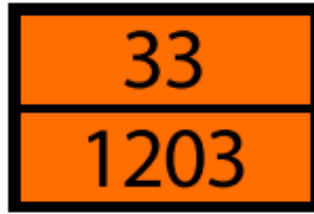
Figura 10: Exemplo de painel laranja incluindo um número de identificação de perigo e um número ONU
