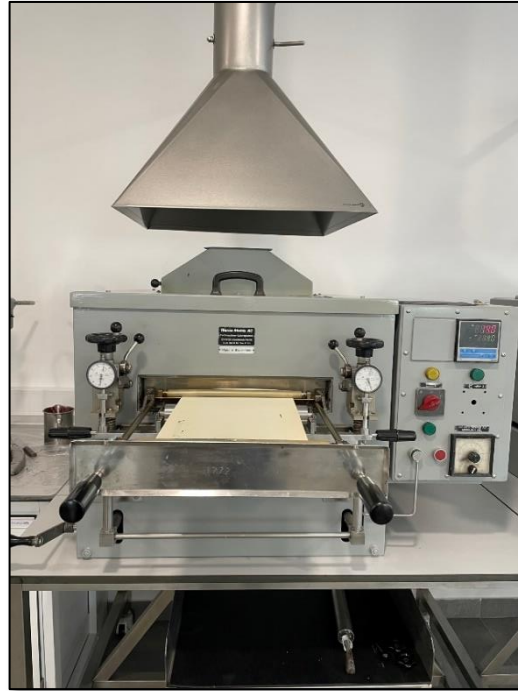
Figura 3.2 - Equipamento W. Mathis A.G. utilizado para recobrimento das pastas a nível laboratorial.
