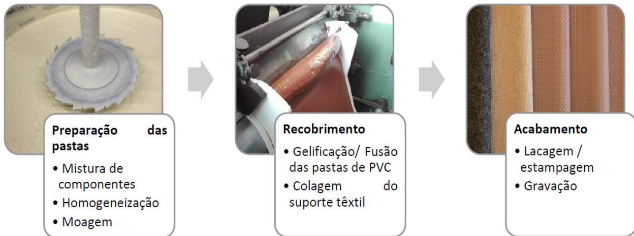
Figura 2.12 - Etapas do processamento de um couro artificial de PVC [3].
