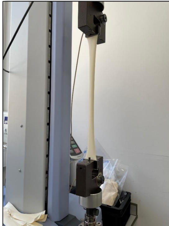
Figura 3.5 - Ensaio de resistência à tração com o Dinamómetro Shimadzu EZ-LX.
