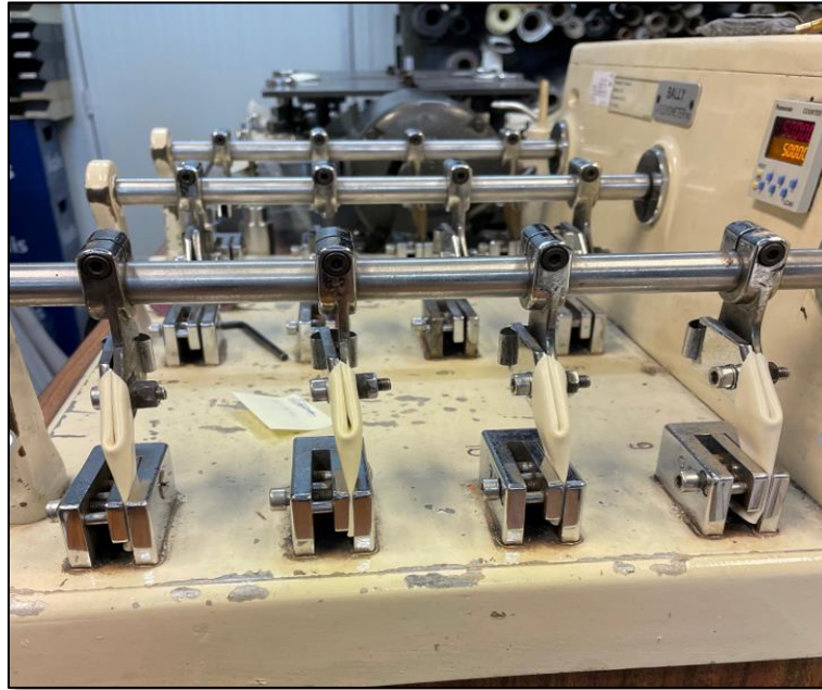
Figura 3.9 - Amostras de couro artificial de PVC posicionadas no suporte de amostras do flexómetro Bally G140.
