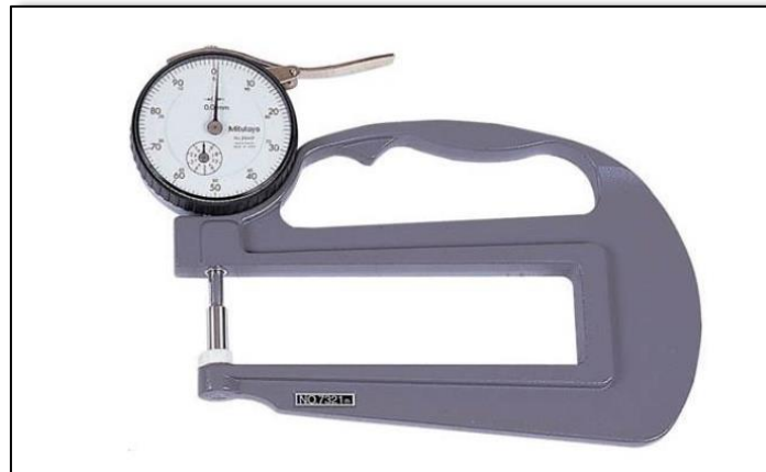
Figura 3.4 - Medidor de espessura utilizado para determinar a espessura dos produtos [5].
