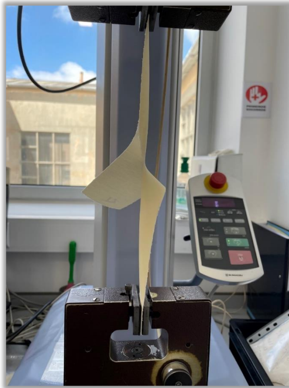
Figura 3.6 - Ensaio de resistência ao rasgamento com o Dinamómetro Shimadzu EZ-LX.
