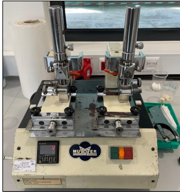
Figura 3.14 - Aparelho utilizado para a realização do ensaio de solidez da cor à fricção.
