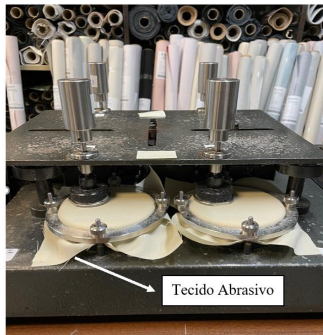
Figura 3.11 – Abrasímetro Martindale usado para a realização do ensaio de resistência à abrasão.
