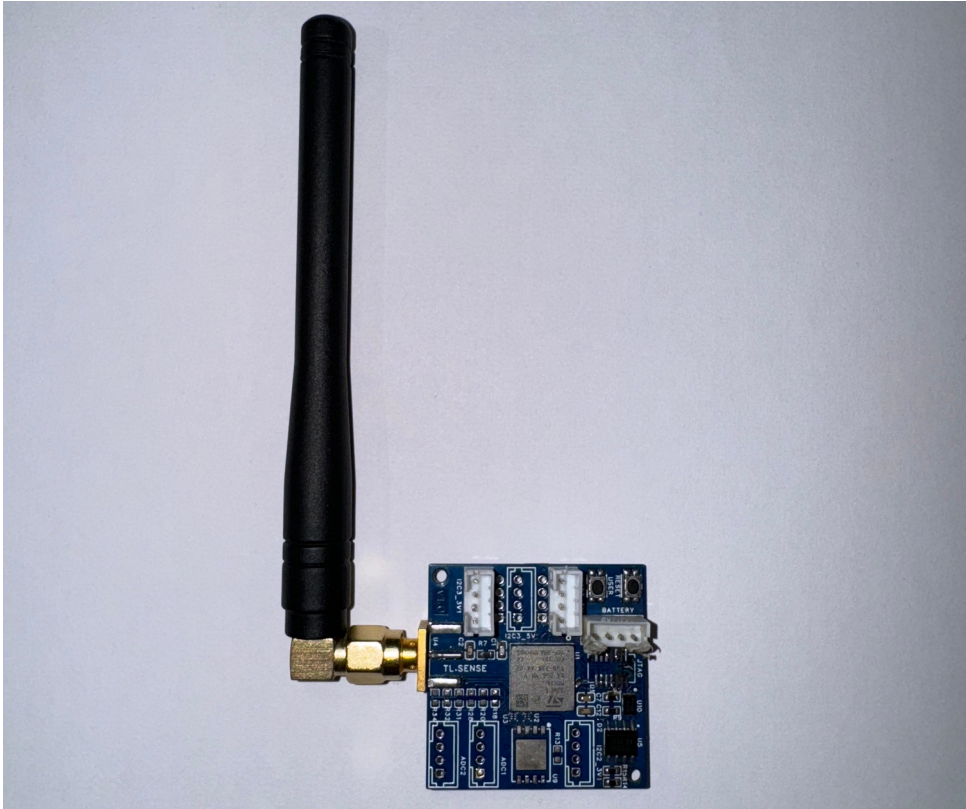
Figura 4.24: TL.SENSE com os componentes mínimos soldados
