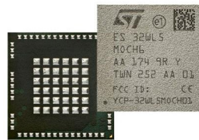
Figura 4.23: Localização dos pinos no microcontrolador
