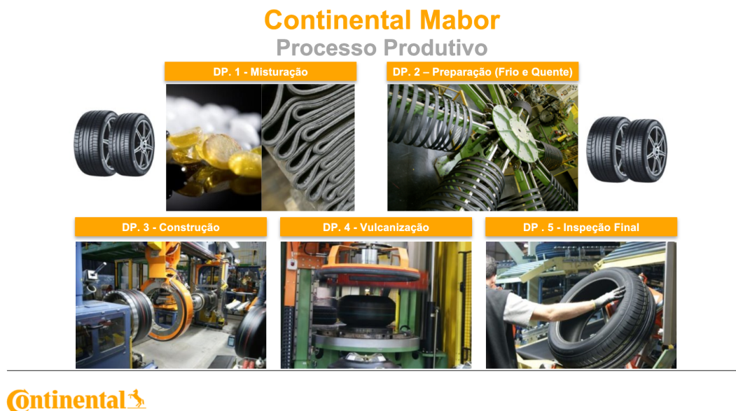
Figura 3.2: Processo Atual da Construção de um Pneu
