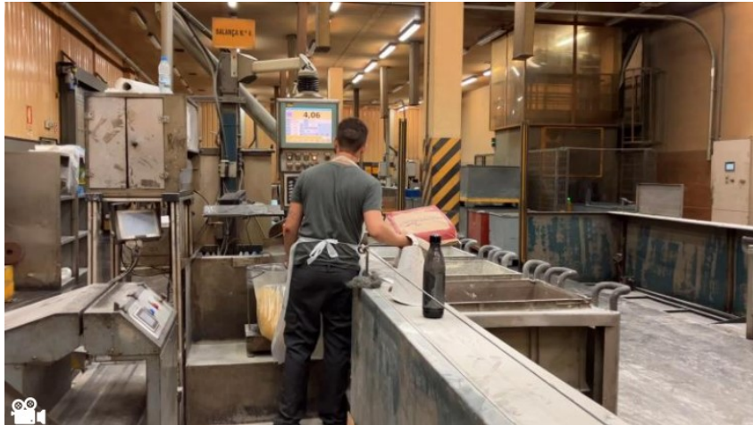
Figura 3.3: Processo Atual da Pesagem e Mistura dos Pigmentos
