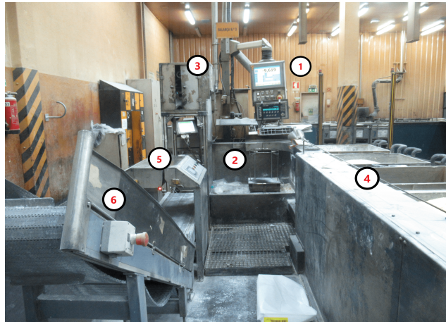
Figura 3.5: Estação de Trabalho: 1-HMI/PLC; 2-Balança Digital; 3-Dispensador de Sacos; 4-Plataforma de Tulhas; 5-Seladora de Sacos, 6-Tapete Rolante + Caixa de Armazenamento
