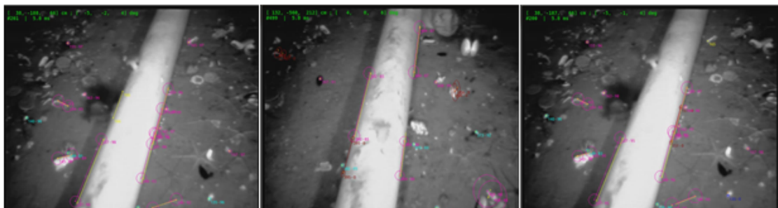
Figura 7.4: Deteção de linhas e pontos num gasoduto.
