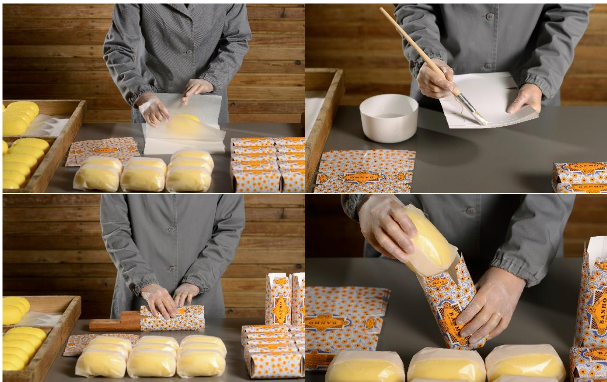
Figura 6 - Diferentes fases do embalamento manual do sabonete
