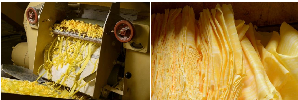
Figura 3 - Laminagem da massa após a mistura dos ingredientes
