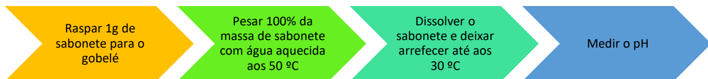
Figura 17 - Determinação do pH do sabonete
