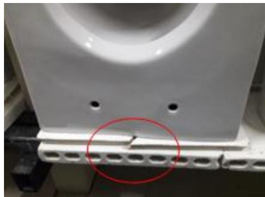
Figura 3.12– Placa refratária partida que, conseqüentemente, deu origem a uma peça empenada [11].
