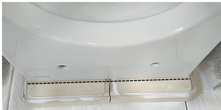
Figura 6.17 – Empeno verificado na bacia da série Two suspensa, após cozedura (5º ensaio).
