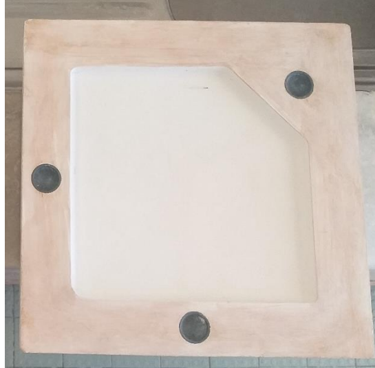
Figura 4.8 – Uma das duas partes do molde final das placas.
