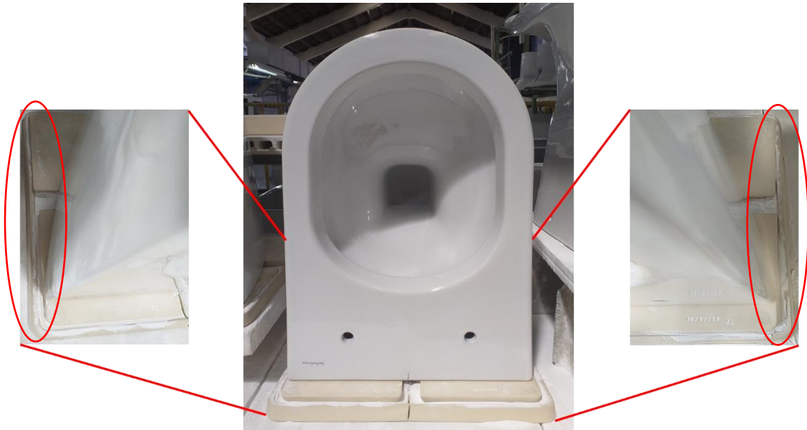
Figura 6.16 – Movimentação verificada pelas placas, após cozedura (5º ensaio).
