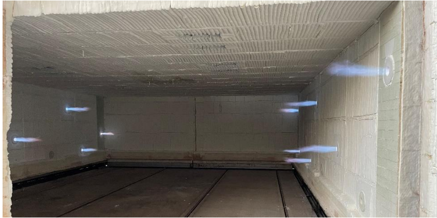
Figura 2.3 – Interior do forno intermitente com os queimadores em funcionamento.
