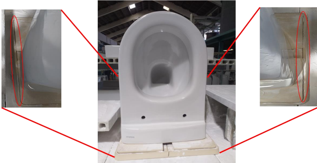
Figura 6.14 – Movimentação verificada pelas placas, após cozedura (4º ensaio).
