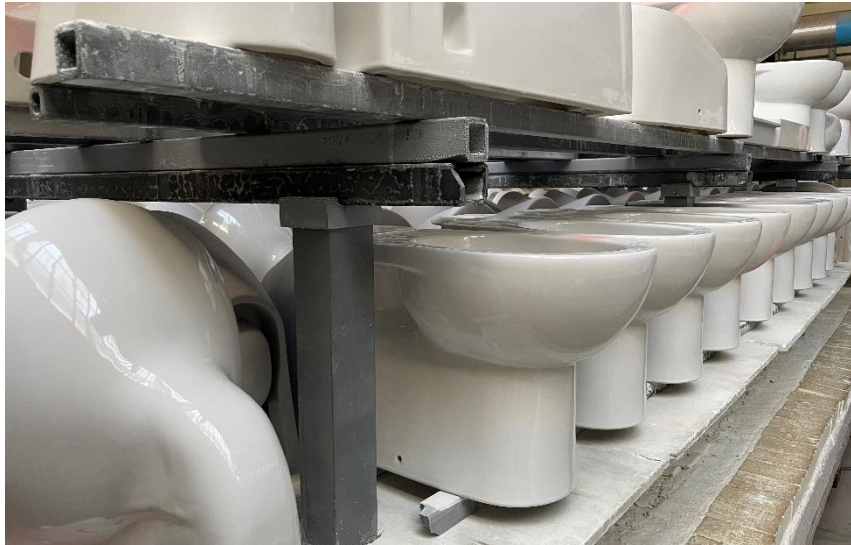
Figura 2.7 - Longarinas e pilares em carboneto de silício, SiC.
