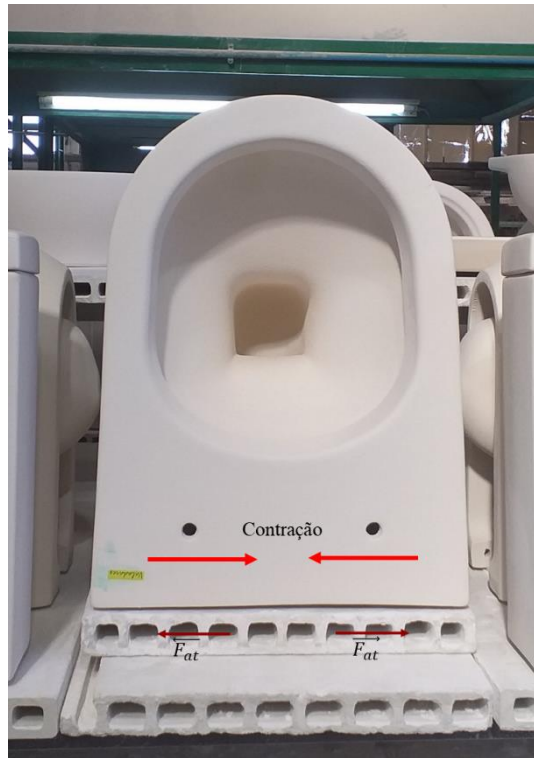
Figura 3.9 – Esquema representativo das direções da contração e força de atrito, durante a cozedura.
