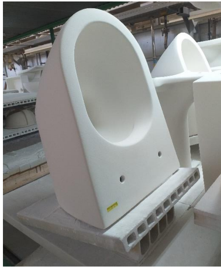
Figura 6.21 – Bacia Two suspensa rimless, enforcada em cima do suporte 1.
