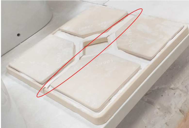
Figura 6.19 – Tabuleiro, originado a partir do molde com 6 pontos de enchimento, fraturado.
