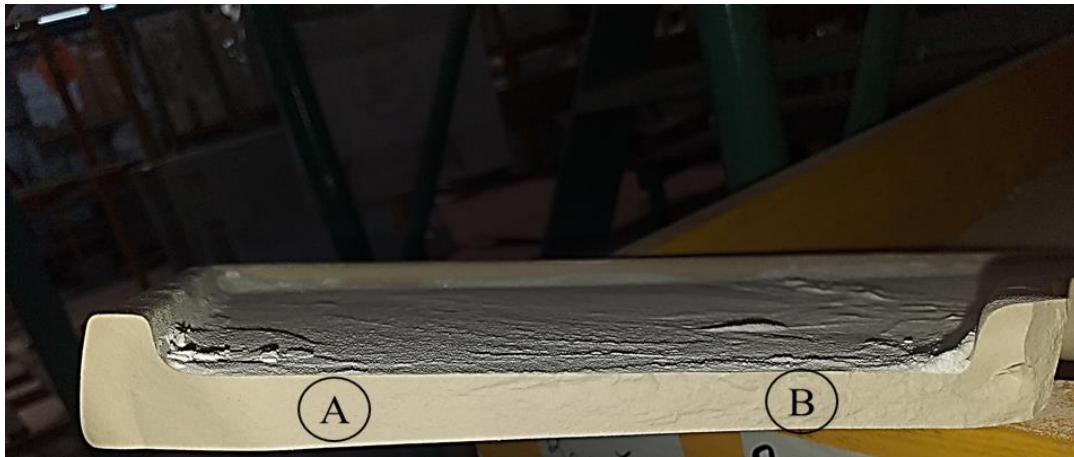
Figura 6.9 – Análise da fratura verificada no tabuleiro.
