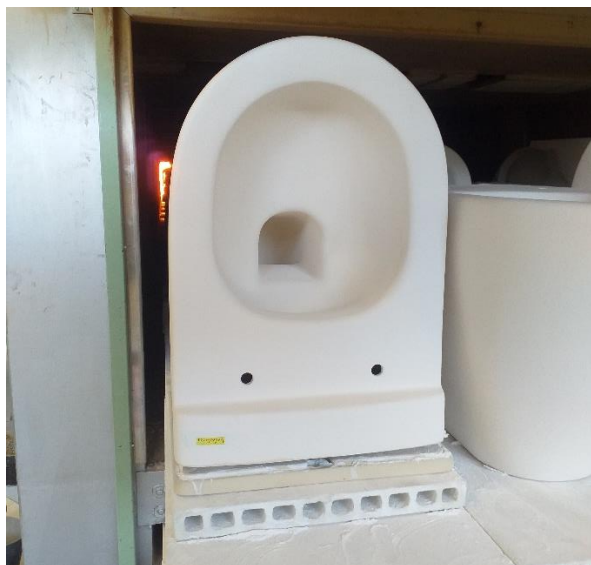
Figura 6.2 – Bacia da série Nautilus suspensa, sobre o suporte desenvolvido.
