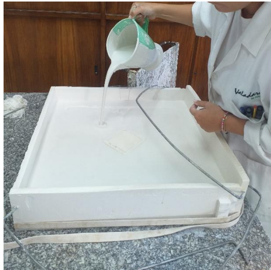
Figura 4.10 – Método de enchimento com gesso.
