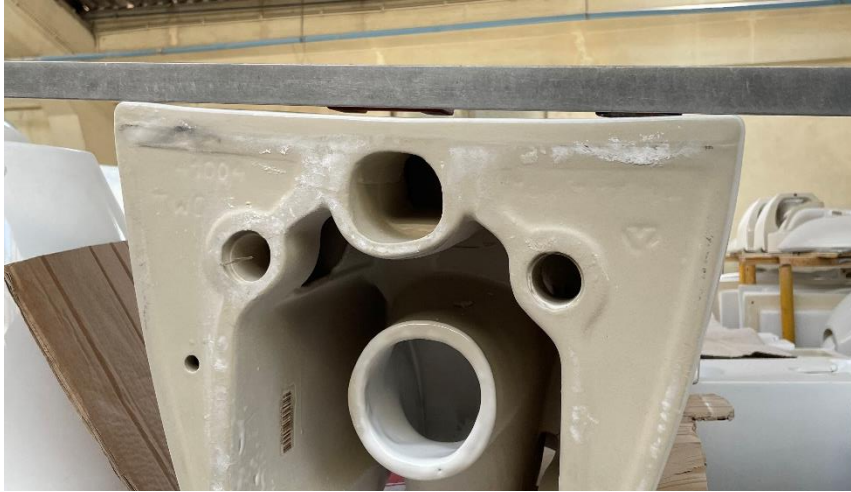
Figura 3.8 – Bacia, da série Two suspensa, empenada.
