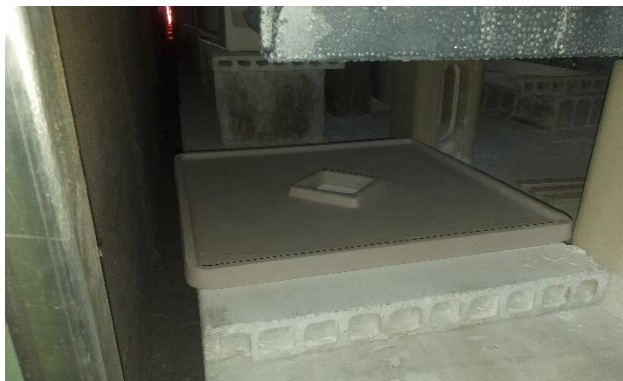
Figura 4.14 – Tabuleiro a iniciar o processo de cozadura, após secagem branca.
