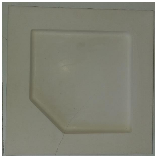
Figura 4.7 – Forma perdida das placas.
