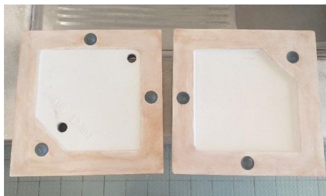
Figura 4.9 – Molde das placas.
