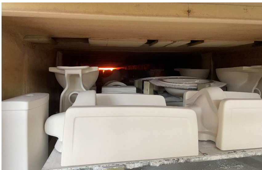
Figura 2.4 - Entrada da loiça num forno de chama aberta.
