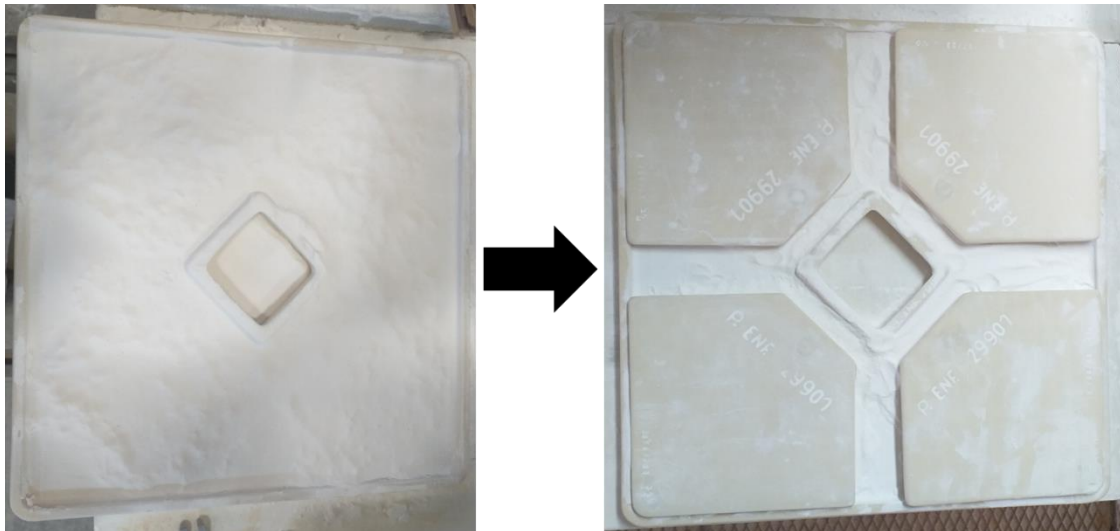
Figura 6.15 – Disposição da alumina no tabuleiro.
