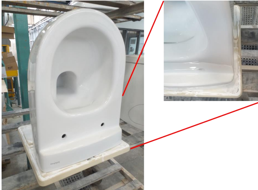
Figura 6.3 – Movimentação verificada pelas placas, após cozedura (1º ensaio).
