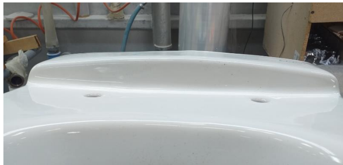
Figura 6.4 – Espaldar da bacia Nautilus suspensa, com uma ligeira deformação (1º ensaio).
