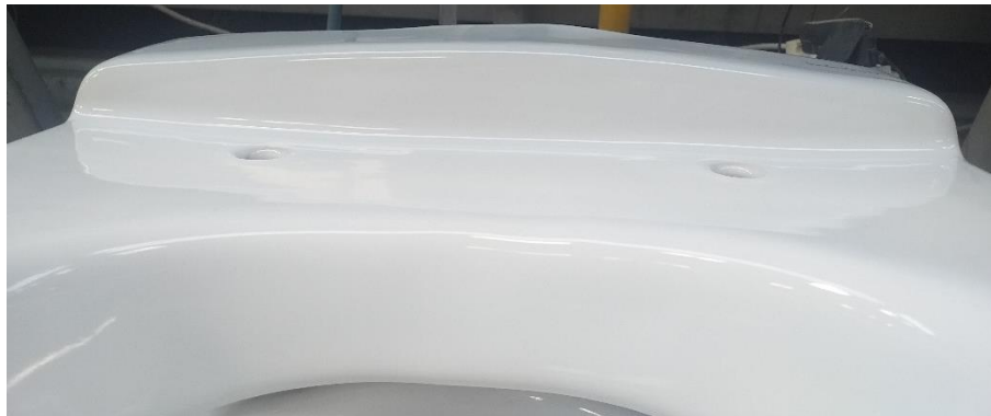
Figura 6.8 – Deformação acentuada apresentada pela bacia Nautilus suspensa (2º ensaio).
