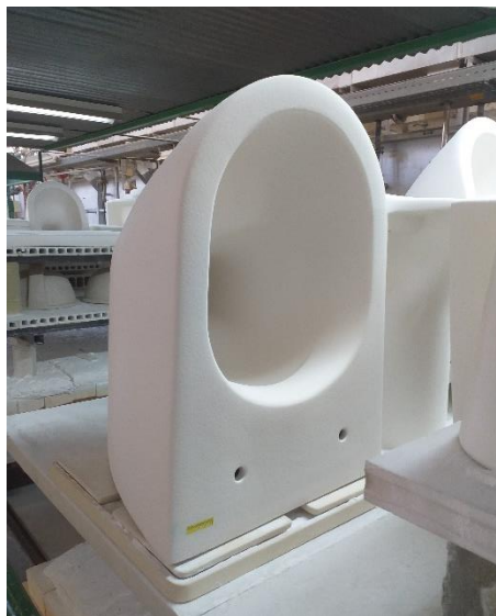
Figura 6.22 – Bacia Two suspensa rimless, enforcada em cima do suporte 2.
