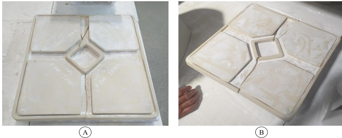
Figura 6.7 – Suportes de sustentação, para as bacias Nautilus (A) e Two suspensas (B), ambos com o tabuleiro fraturado.
