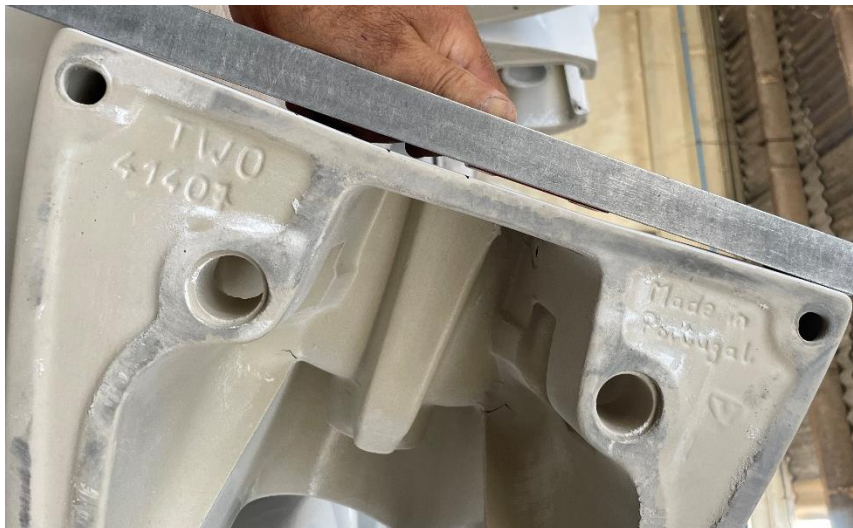
Figura 3.7 – Bidé, da série Two suspensa, empenado.
