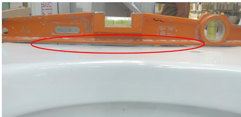
Figura 6.13 – Empeno verificado na bacia da série Two suspensa, após cozedura (3º ensaio).
