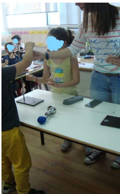
Figura 15 - Utilização do sonómetro na medição do som produzido pela buzina, tendo como obstáculo a placa de acrílico
