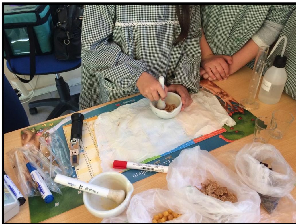
Figura 11 - 2º passo – Triturar a amostra com a ajuda do almofariz
