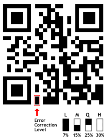
Figura 12 - Módulos que indicam o nível de correção de erro de um QR Code (QRStuff, 2011)
