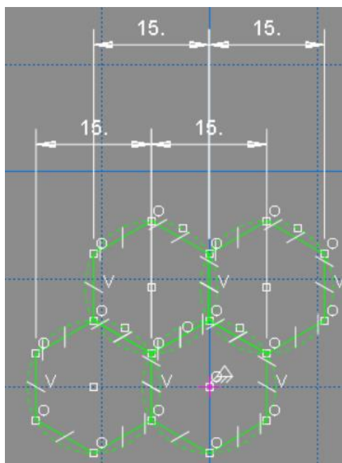
Figura 74 – Geometria de hexágonos impossível de extrudir
