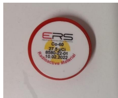
Figura 7 – Fonte de ^{60}\text{Co} selado (modelo ERS® - SPT8580)
