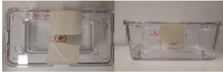
Figura 9 – Fotografia real da estrutura utilizada para a irradiação dos peixes zebra, com vista superior e lateral
