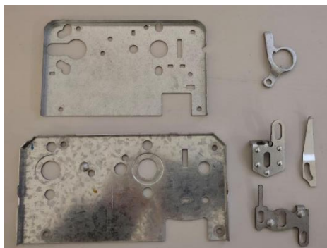
Figura 22 - Componentes de fechaduras produzidos por estampagem
