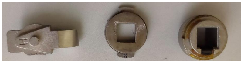
Figura 27 - Componentes de fechaduras produzidos por sinterização
