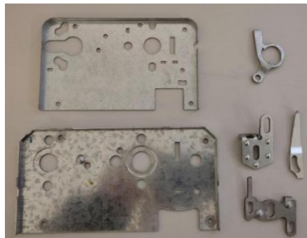
Figura 33 - Componentes de fechaduras acabados com processos de galvanização
