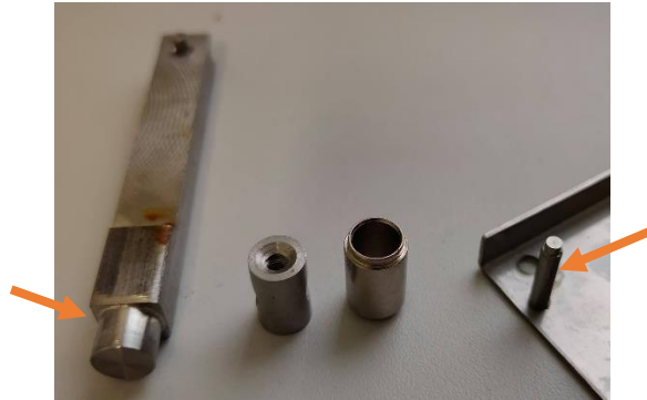
Figura 28 - Componentes de fechaduras produzidos por torneamento
