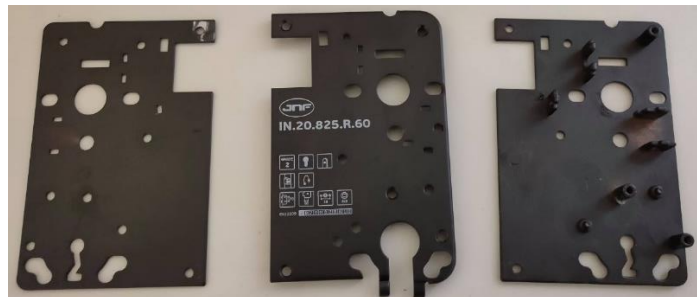
Figura 32 - Componentes de fechaduras acabados com pintura eletrostática
