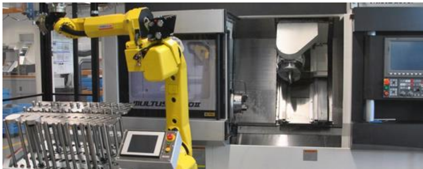
Figura 41 - Exemplo de aplicação de automatização flexível [38]
