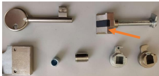
Figura 26 - Componentes de fechaduras produzidos por fundição injetada de ZAMAK
