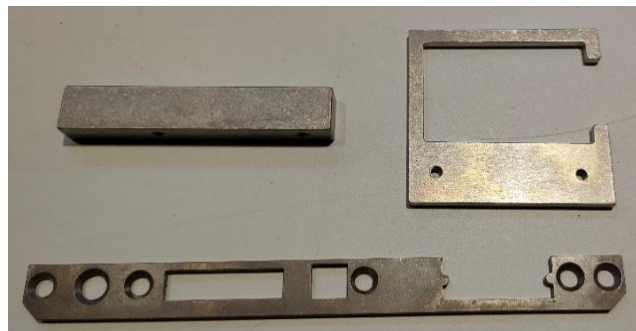
Figura 37 - Componentes utilizados em fechaduras que utilizam vibro-acabamento
