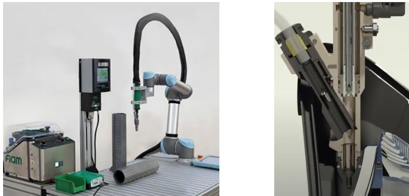
Figura 85 - Equipamento selecionado para realizar o aparafusamento robotizado [57]
