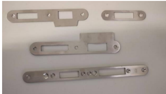
Figura 30 - Componentes de fechaduras produzidos por corte de laser
