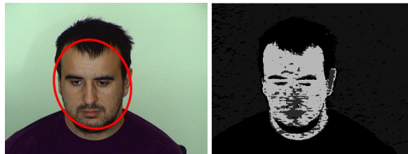
Figura 5.9: Exemplo de saída do Camshift e projeção de vídeo, para V_{min} 50 e S_{min} 25
