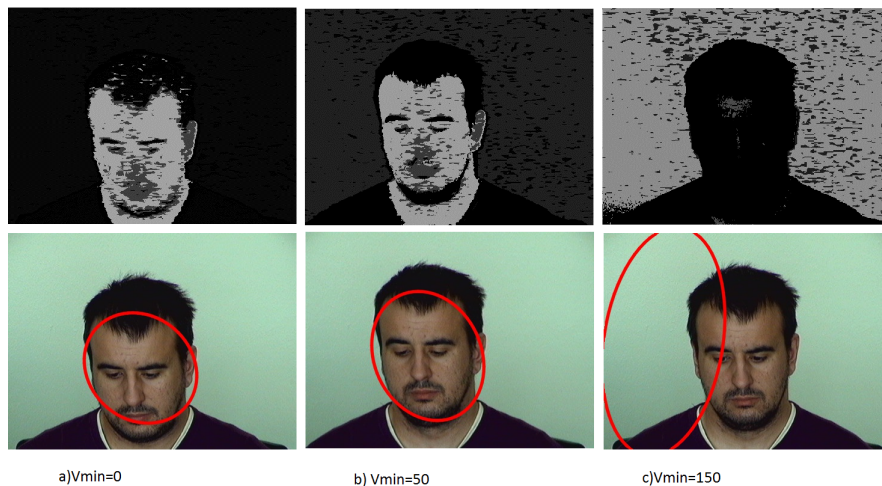
Figura 5.7: Representação projeção de fundo e saída do Camshift para diferentes valores de V_{min}
