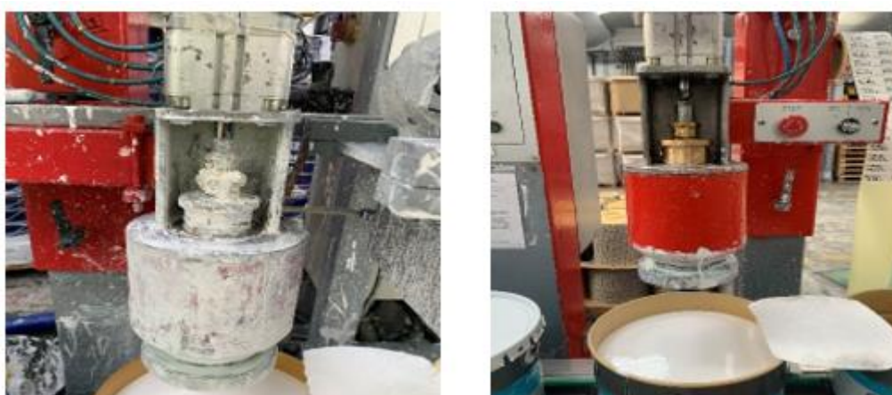
Figura 28 - Antes (imagem da esquerda) e depois (imagem da direita) da lubrificação do bico de enchimento
