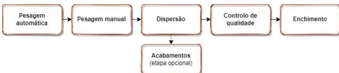
Figura 5 - Etapas de fabrico de tintas de base-aquosa
