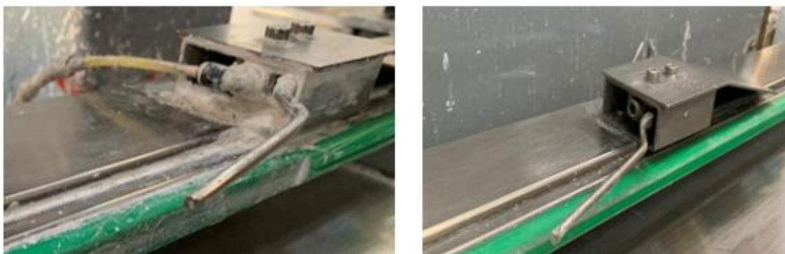
Figura 27 – Antes (imagem da esquerda) e depois (imagem da direita) da limpeza dos sensores
