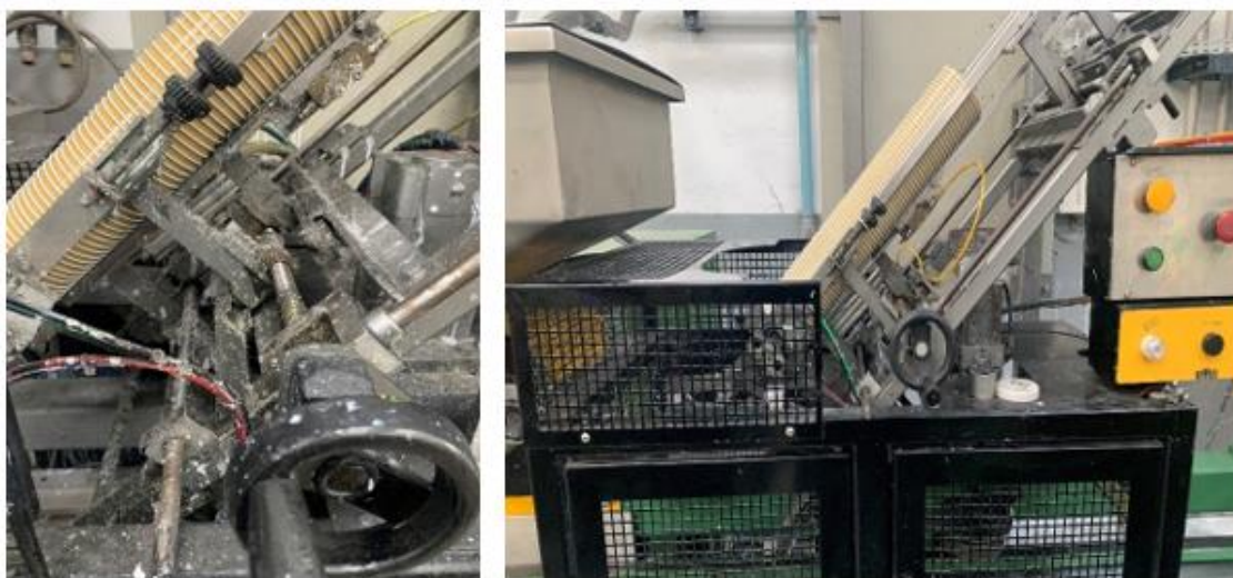
Figura 31 - Antes (imagem da esquerda) e depois (imagem da direita) da limpeza e lubrificação da estação de tamponagem
