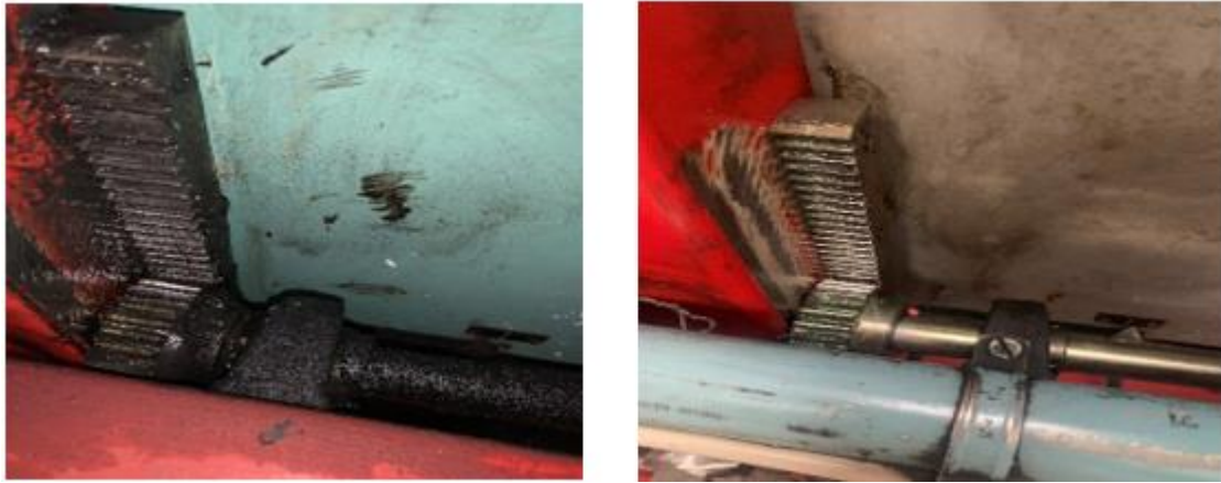
Figura 32 - Antes (imagem da esquerda) e depois (imagem da direita) da lubrificação das engrenagens do paletizador
