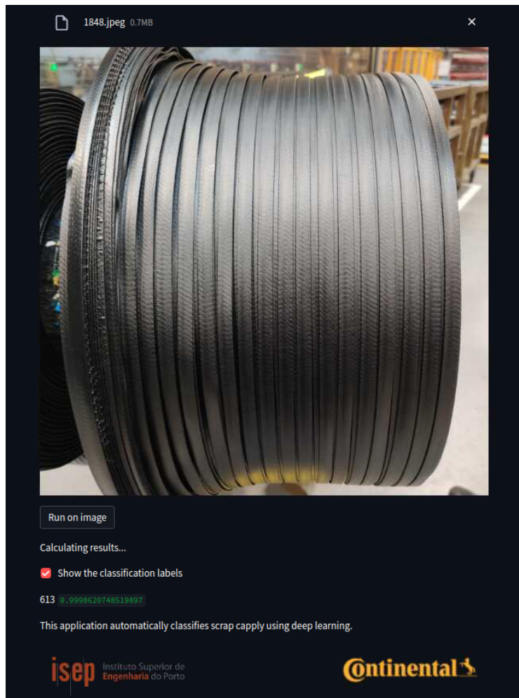
Figura 5.14: Testes na plataforma (Etiqueta 613 - "Mau enrolamento/distribuição irregular").
