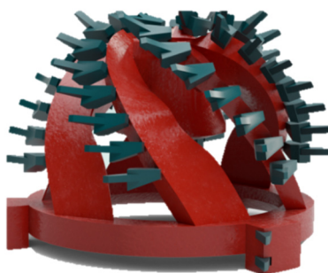
Figura 11 - Cabeça de corte de uma draga de corte e sucção, DEME
