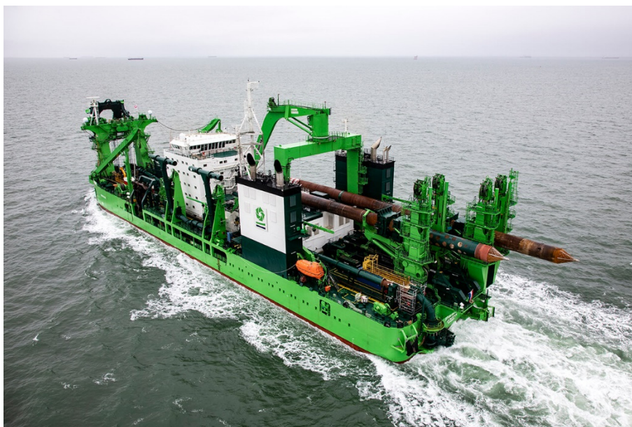
Figura 8 - Dragagem de corte e sucção, pertencente à empresa DEME denominada como "Spartacus" ( https://www.deme-group.com/ )
