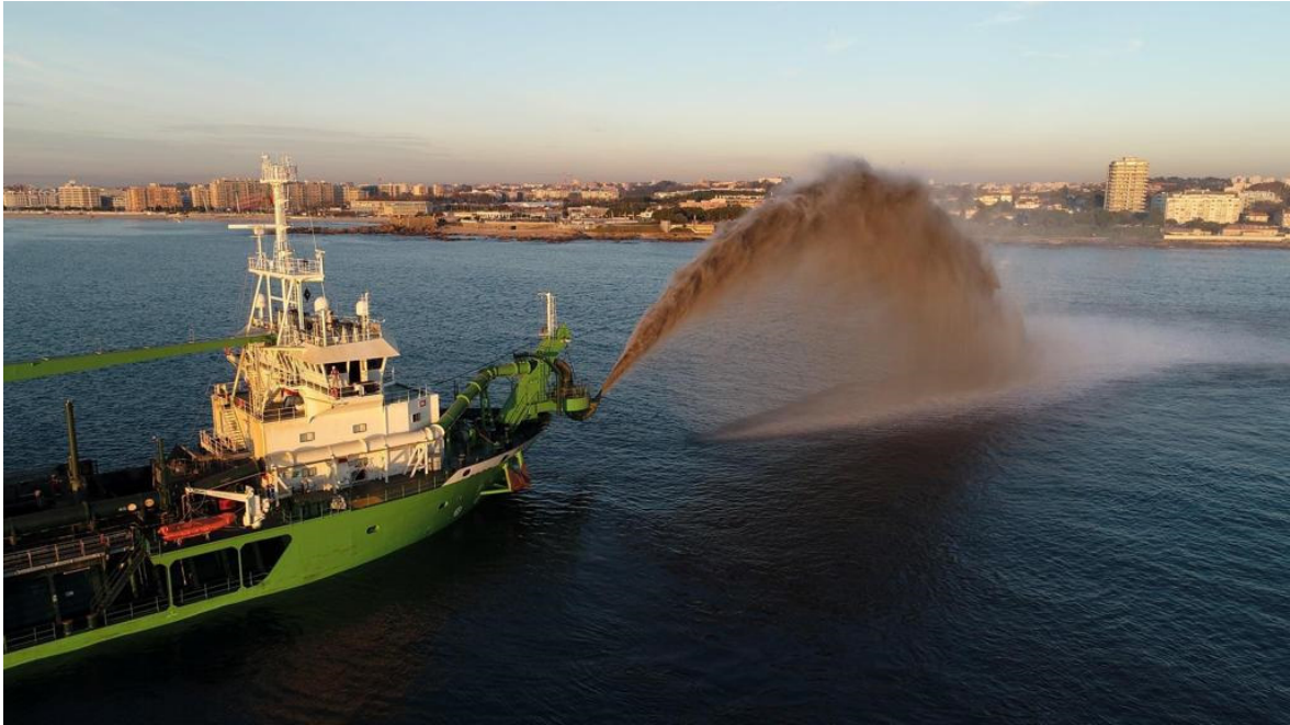
Figura 22 - Dragagem a descarregar o material por efeito "Rainbow", gentilmente cedido por APDL
