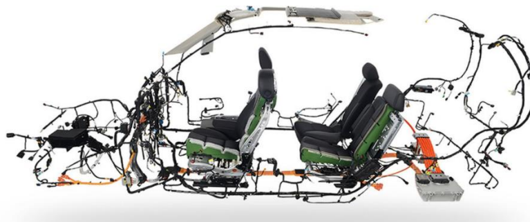
Figura 10 - Exemplos de cablagem utilizada no automóvel (Yazaki, 2019)
