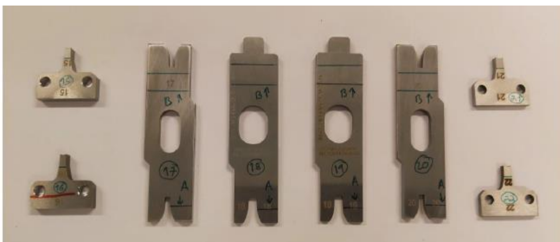
Figura 65 - Identificação dos cortes realizados nas amostras submetidas a análise (ferramentas 15 a 22): corte A – zona funcional; corte B – zona não útil.
