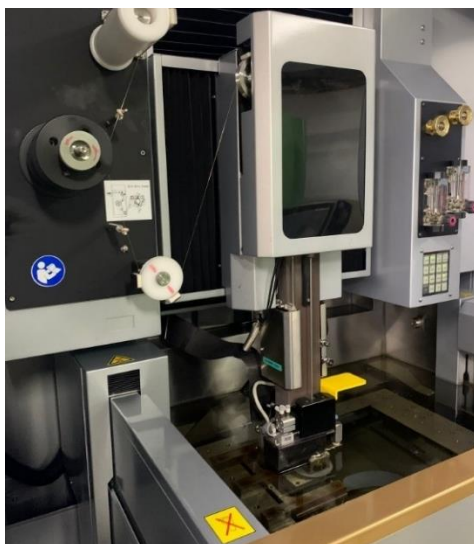
Figura 42 - Interior de um centro de erosão a fio
