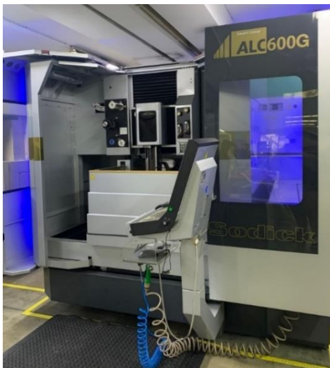
Figura 41- Centro de erosão de fio da R&amp;B
