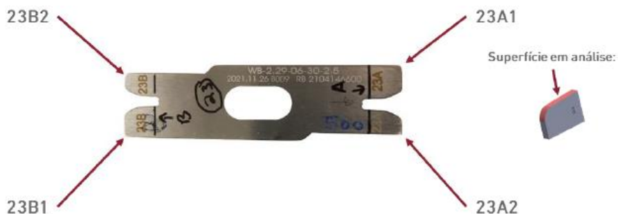
Figura 81 - Identificação dos cortes realizados e respetivas amostras extraídas da ferramenta de cravação nº 23: lado 23A – 500.000 ciclos de utilização; lado 23B – 30.000 ciclos de utilização.
