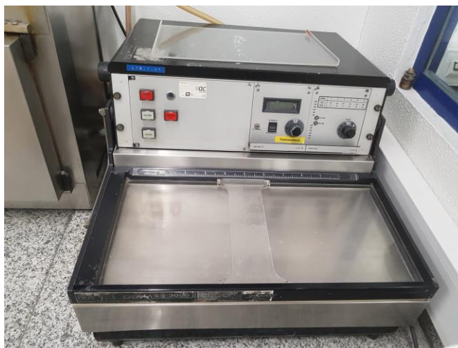
A.5 – Representação do equipamento da determinação da temperatura mínima de formação de filme.
