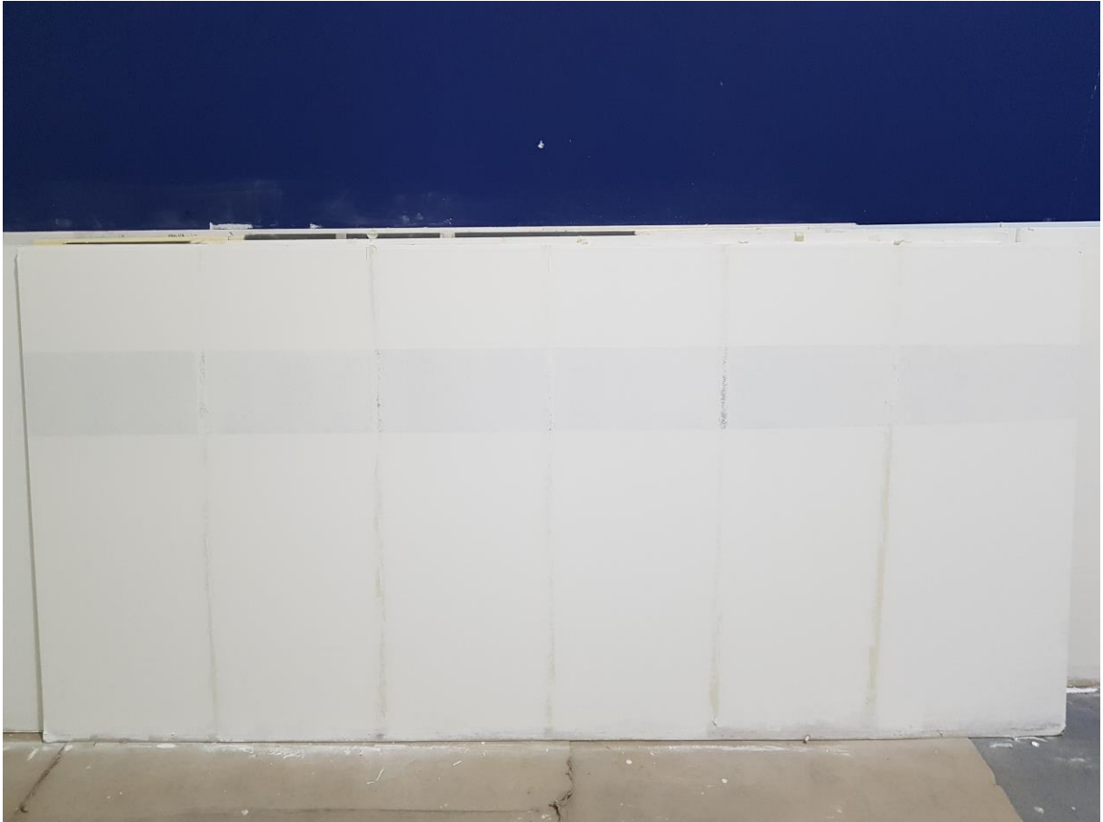
Figura 4.3 - Representação do painel após aplicação dos ensaios iniciais (1 a , 2 a e 3 a faixa da esquerda para a direita) juntamente com as tintas referência (4 a , 5 a e 6 a faixa da esquerda para a direita).
