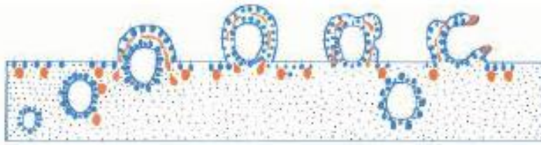
Figura 1.9 - Funcionamento de um agente antiespuma numa película de tinta [5].
