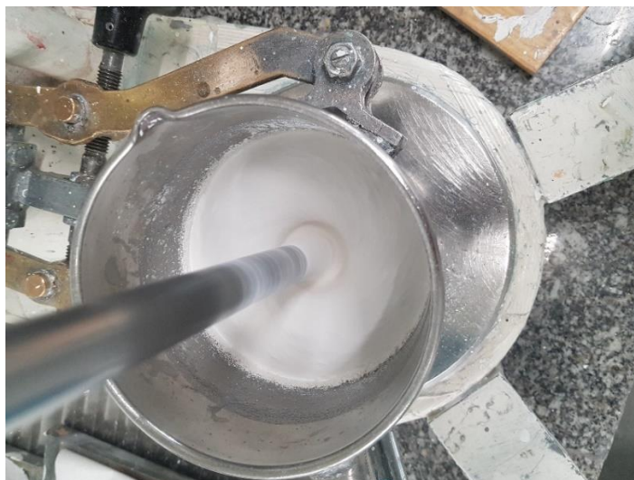
Figura 3.1 - Representação do vortex na produção de uma tinta. [Fotos tiradas durante o estágio]
