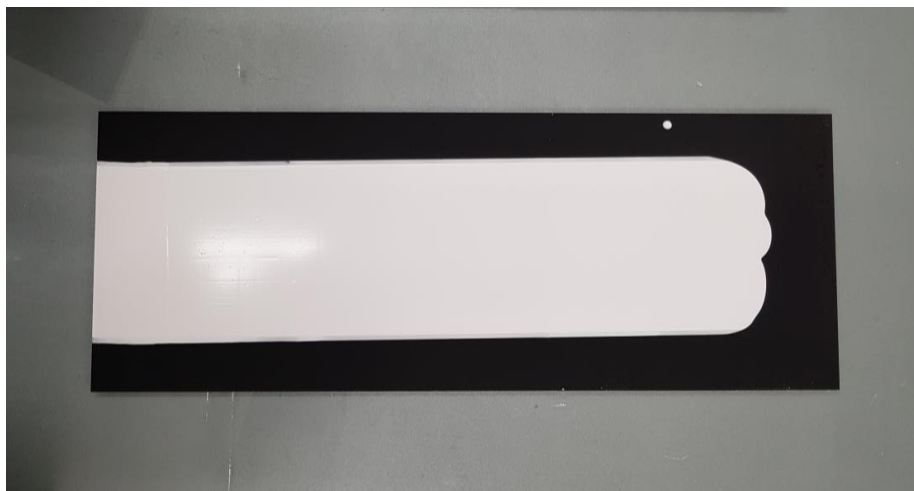
Figura 4.14 - Exemplo de aplicação de tinta em folha Leneta de PVC para ensaio de esfrega húmida.
