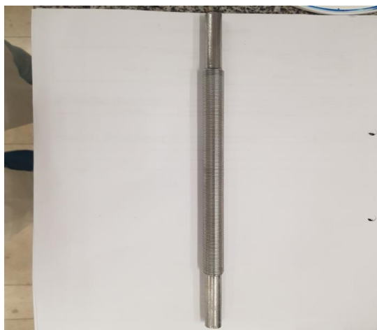
Figura 2.8 - Representação do filmógrafo para aplicação de um filme de tinta para determinação do poder de cobertura. (Fotos tiradas durante o estágio)
