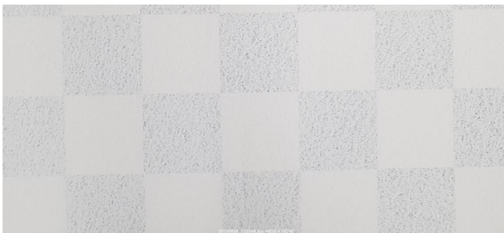
Figura 4.8 - Avaliação da lacagem do ensaio 29440/25, assim como o poder de cobertura, vista de uma forma ampliada.
