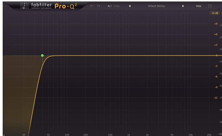
Figura 5 - Equalização da resposta de Frequência das Genelec1031A
