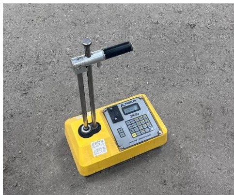
Figura 34-Foto do gamadensímetro usado em obra
