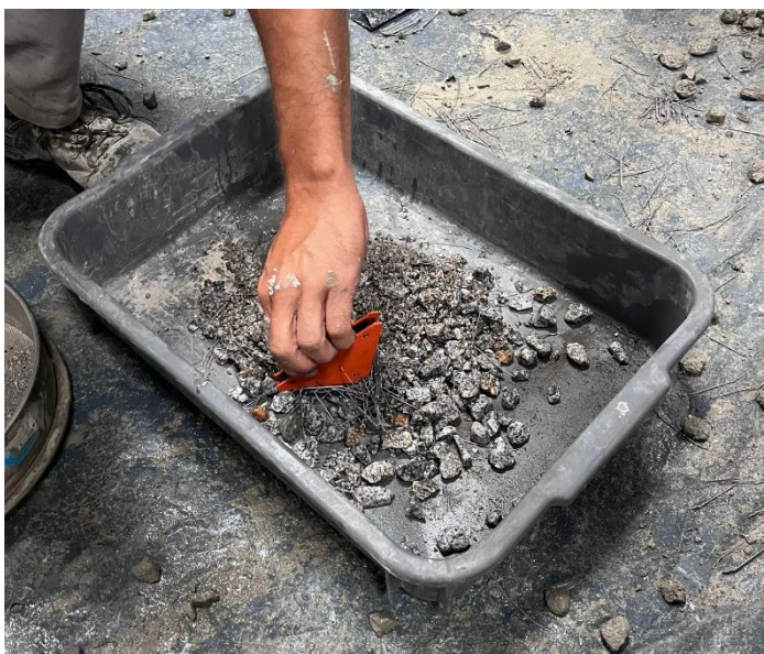
Figura 29-Separação das fibras metálicas no ensaio de determinação da dosagem de fibras em obra, usando íman
