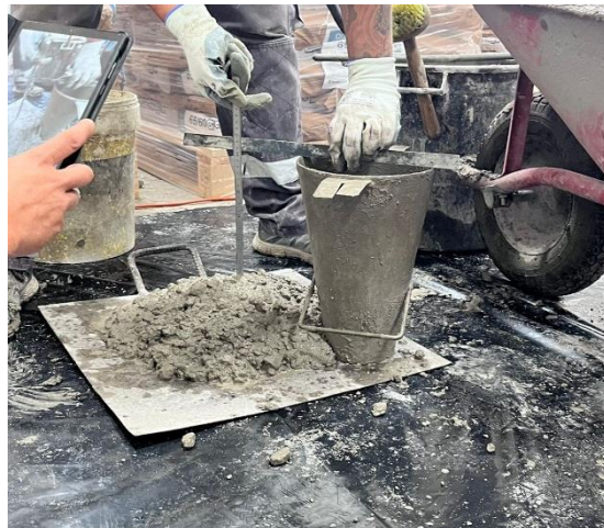
Figura 28-Foto ao Ensaio de Slump realizado em obra (medição do abaixamento)
