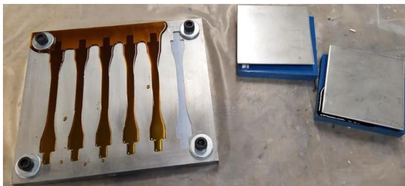
Figura 86: Estado dos provetes bulk e dos moldes de silicone, pós-cura
