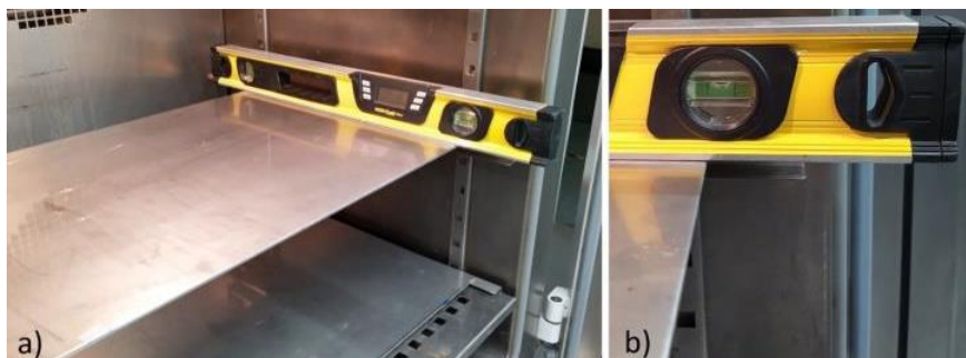
Figura 91: a) nivelamento dos dois tabuleiros de sacrifício, b) estado do nível
