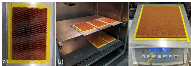
Figura 94: a) colagem do núcleo a um laminado 150×100 mm 2 , b) metades das estruturas sandwich de drop-weight em estufa para cura, c) colagem do núcleo a um laminado 300×300 mm 2
