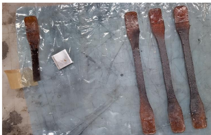
Figura 137: Descolagem dos tabs de alumínio e resto do provete 5
