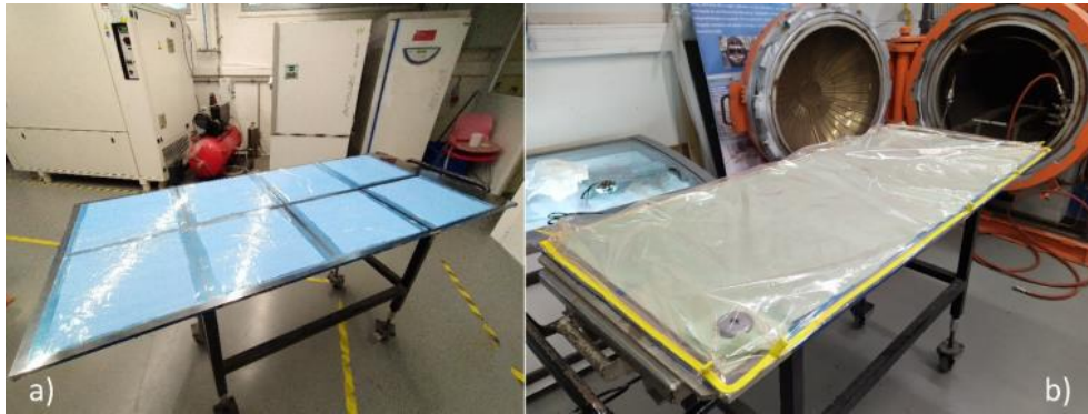
Figura 75: a) deposição dos oito laminados 300×300 mm 2 a curar, b) mesa do autoclave pronta a seguir para a cura dos laminados
