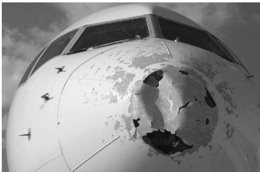
Figura 23: Danos catastróficos causados pelo impacto de granizo no cone frontal na aeronave [100]
