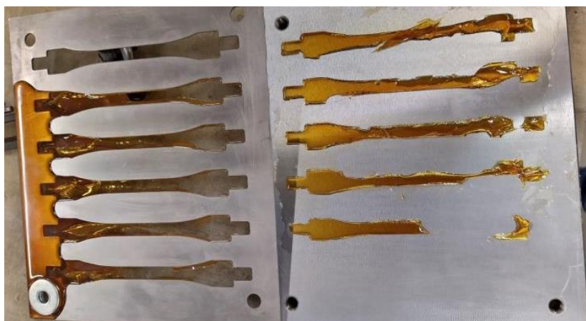
Figura 87: Tentativa falhada de desmoldar os provetes do molde de aço
