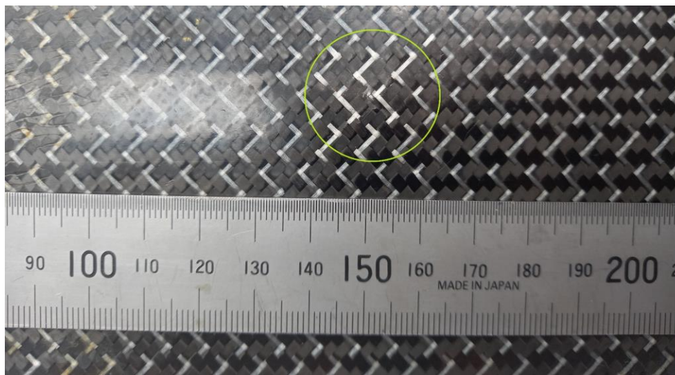
Figura 150: Provete 1, face traseira após condicionamento e segundo impacto
