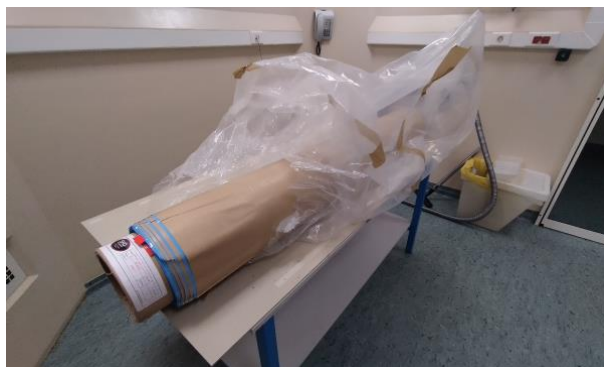
Figura 68: Invólucro do rolo a ser retirado para estabilização e prevenção de influência de humidades
