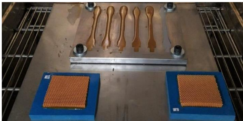
Figura 85: Molde de aço com cinco provetes preenchidos (de notar que o excesso de material é propositado uma vez que o mesmo se encontra sobre o efeito de expansão térmica) e moldes de silicone com metades de estrutura sandwich para teste de superfícies
