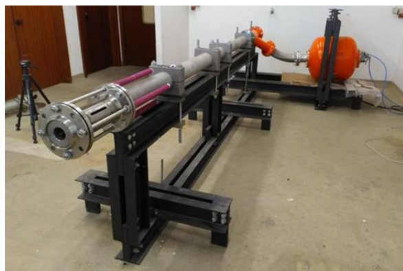
Figura 35: Canhão de ar comprimido usado em ensaios de impacto por projectil (disponível nas instalações do Instituto de Soldadura e Qualidade, ISQ) [128]
