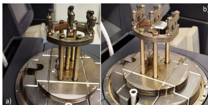
Figura 100: Provete colocado em posição no aparelho de DMA; a) vista lateral, b) vista ¾
