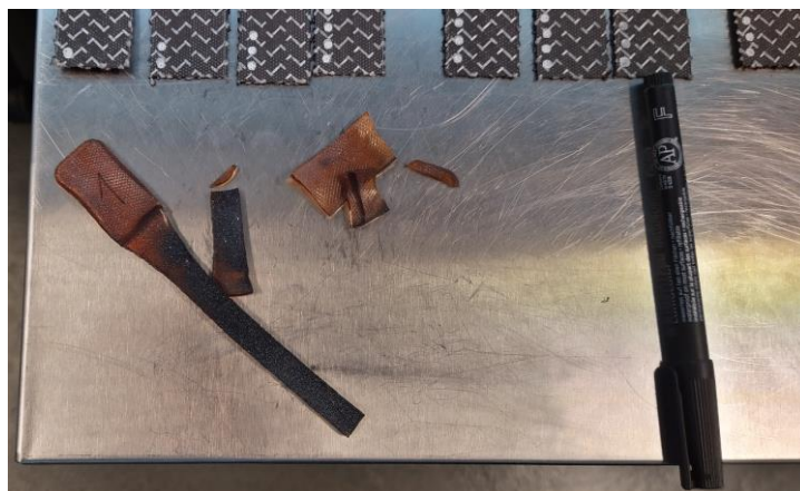
Figura 136: Destruição do provete 1 de Reverlink™ devido à elevada T sentida
