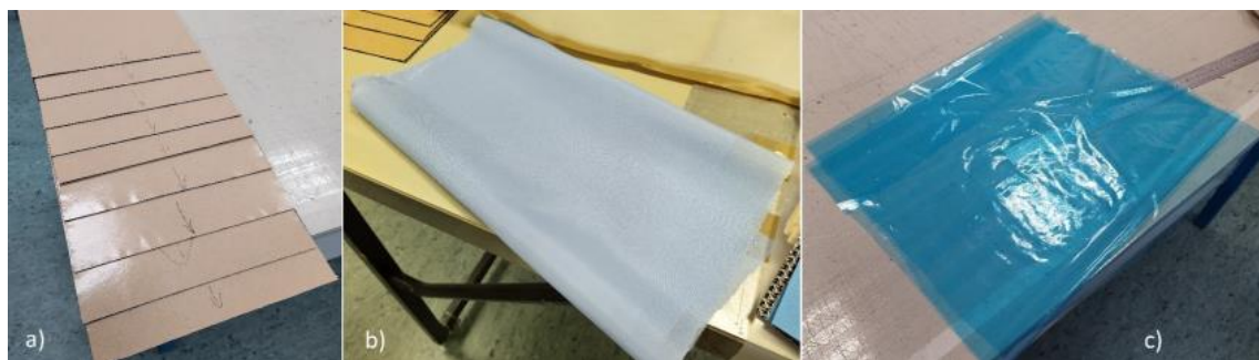
Figura 74: a) aresta alinhada no gabarito, b) amostra de peel ply , c) amostra de filme de Teflon®
