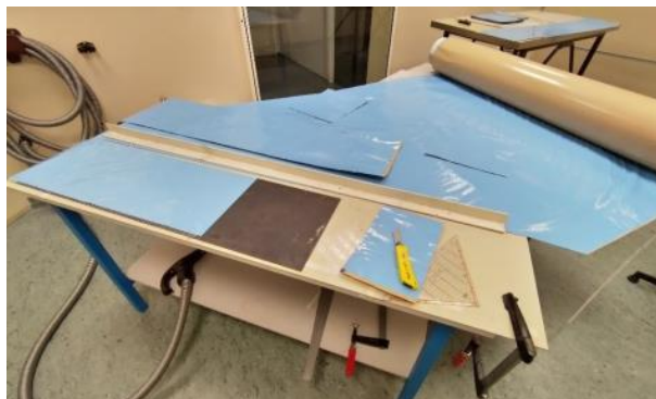
Figura 70: Procedimento de corte das camadas 300×300 mm 2 (ilustrado para orientação [±45°] e também aplicado em [0°/90°])
