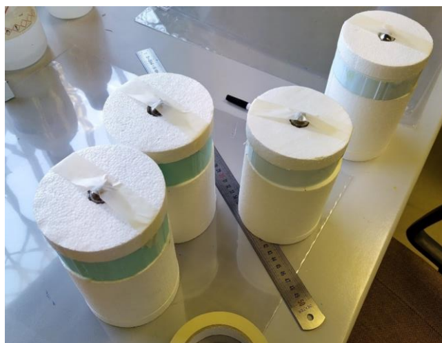
Figura 153: Cartuchos fabricados em esferovite e espuma de XPS (disponível nas instalações do ISQ)
