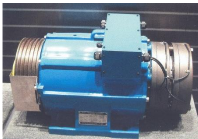
Figura 2.1 - Motor elétrico - máquina sem redutor de um elevador
