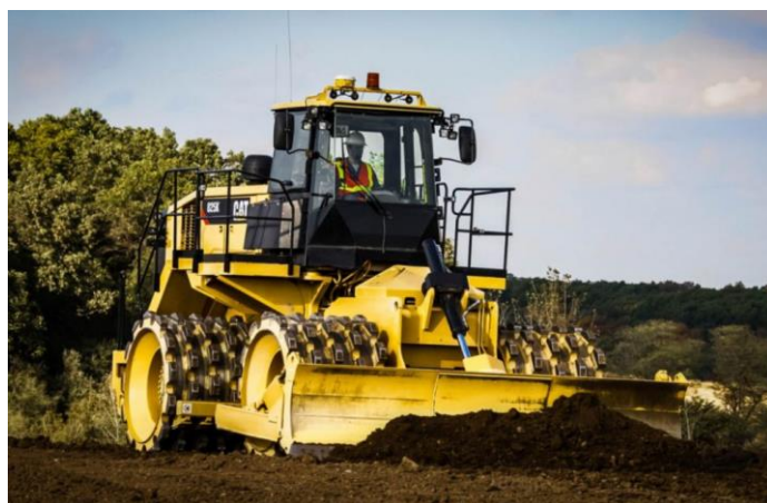
Figura 3.6 – Exemplo de um cilindro de pés de carneiro [9].
