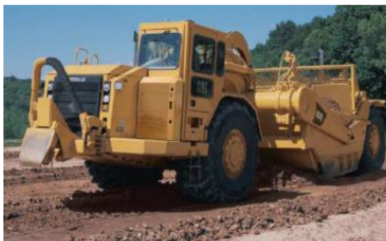
Figura 3.4 – Exemplo de motoscraper [5].
