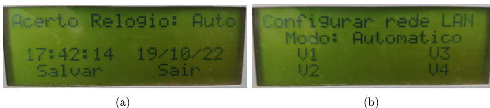
Figura 7.20: Menus do controlador do sistema de rega auxiliar (a) Configuração do relógio (b) Configuração do modo de operação
