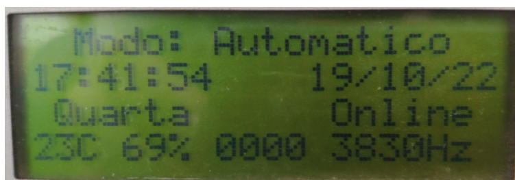
Figura 7.19: Menu principal do controlador remoto do sistema de rega auxiliar
