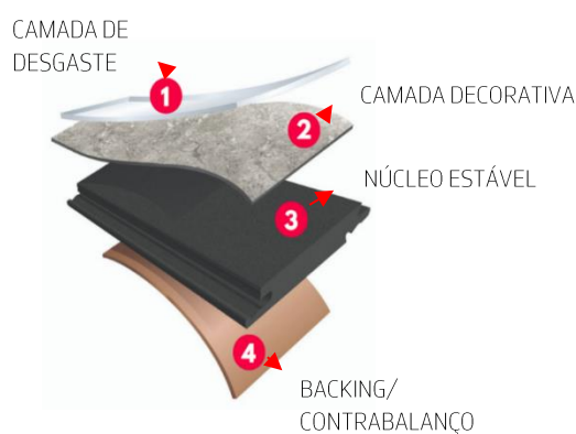
Figura 22- Esquema da composição do pavimento vinílico. Fonte: Listor.
