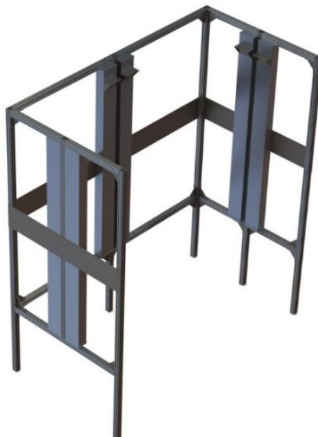
Figura 59 - Estrutura que sustenta e eleva o sistema de ventosas.
