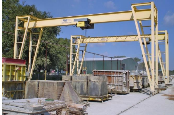
Figura 32 - Exemplo de dois pórticos monoviga [42].
