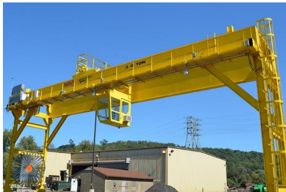
Figura 33 - Exemplo de um pórtico biviga [42].
