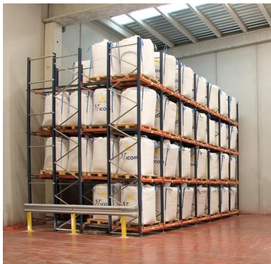
Figura 20 - Mercadoria armazenada em profundidade [26].
