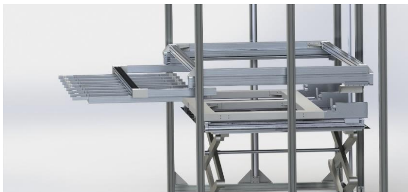
Figura 65 - O sistema de ventosas avança sobre a chapa.
