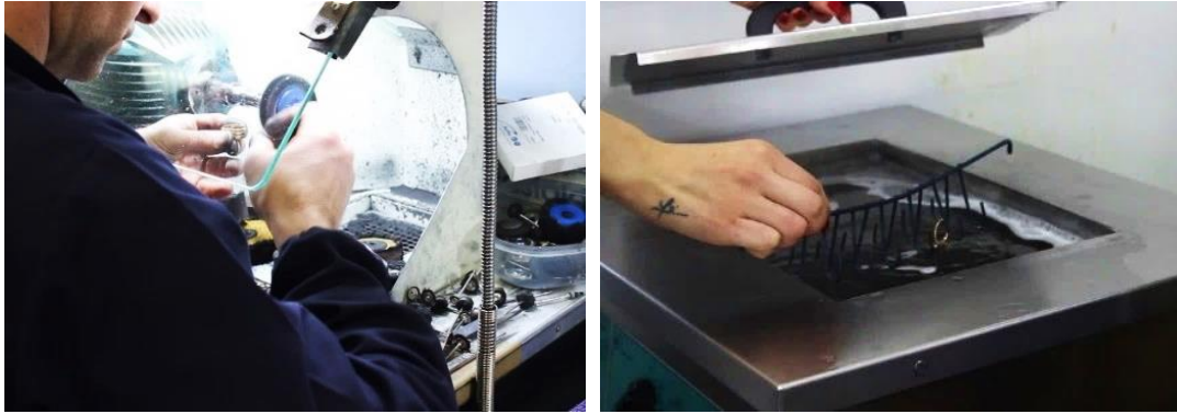
Figura 132 – À esquerda, o polimento por motor. À direita, o polimento por ultrassom na JCF.
