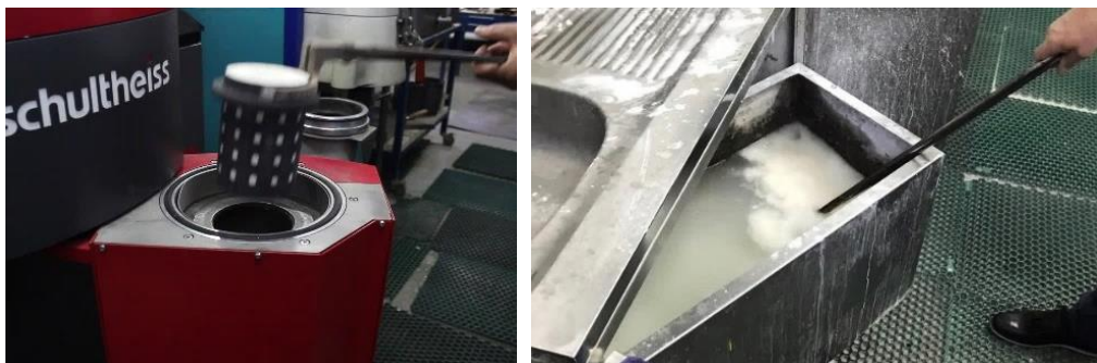
Figura 124 – À esquerda encontra-se o cilindro a ser colocado na máquina de fundição. À direita, o cilindro está a ser mergulhado para remover o gesso (pós fundição) na JCF.
