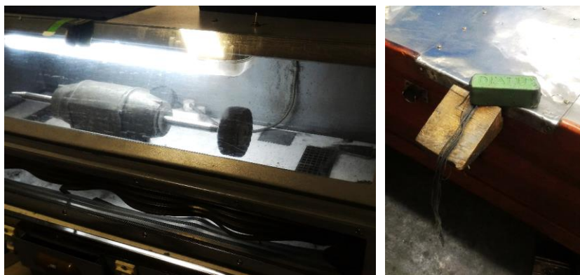
Figura 145 – Polimento por motor (esquerda) e polimento por fio de algodão e sabão (direita).
