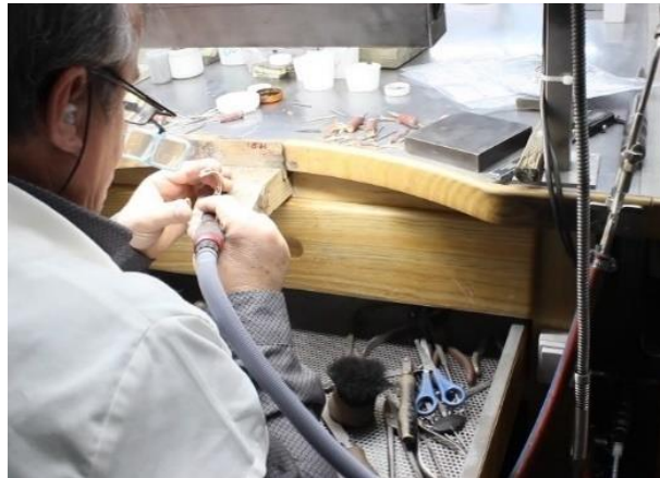
Figura 127 – Ourives a apurar a peça (trabalho de bancada) na JCF.
