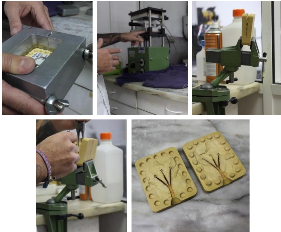
Figura 119 – Vulcanização de moldes na JCF.
