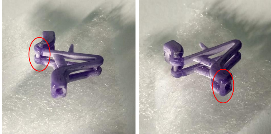
Figura 180 – Peça que sofreu danos unida por cola. A fragilidade da cera não permitiu testar a peça no seu todo devido à rotura nos dois pontos assinalados.
