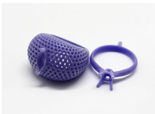
Figura 117 – Modelos em cera obtidos pela impressora 3D na JCF.
