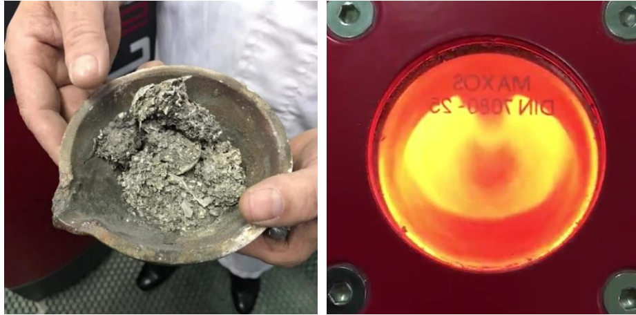
Figura 183 – Reaproveitamento de material na criação da liga (esquerda) e posterior fundição (direita).
