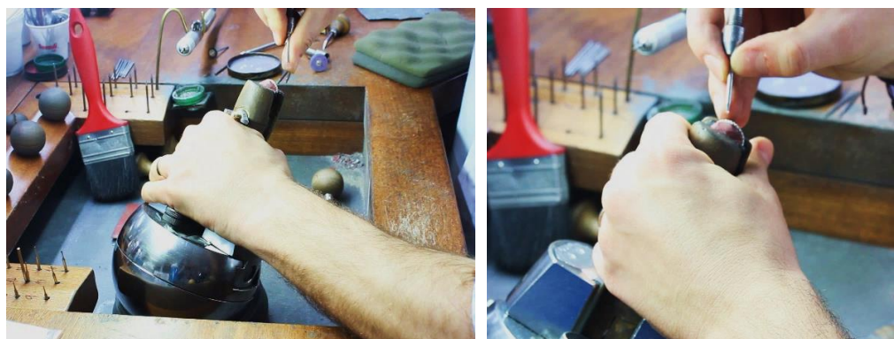
Figura 129 – Cravador a utilizar um mandril com um perloirs no processo de cravação na JCF.
