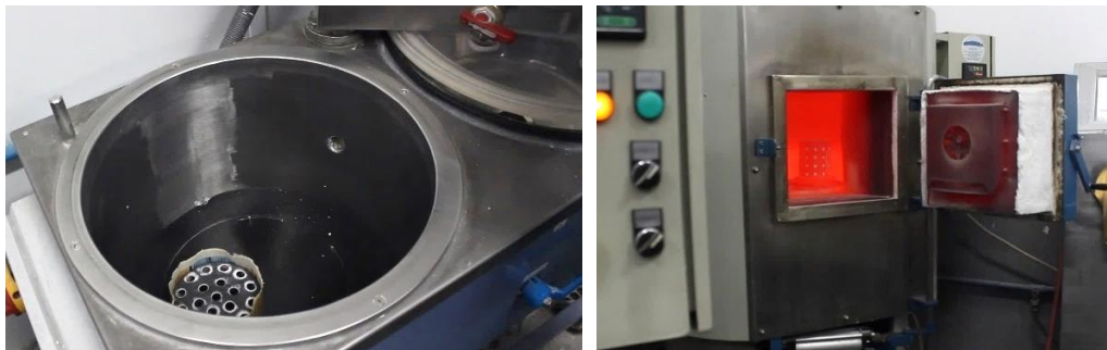
Figura 122 – Cilindro forrado com jornal na centrífuga (esquerda) e cilindro na mufla (direita) na JCF.
