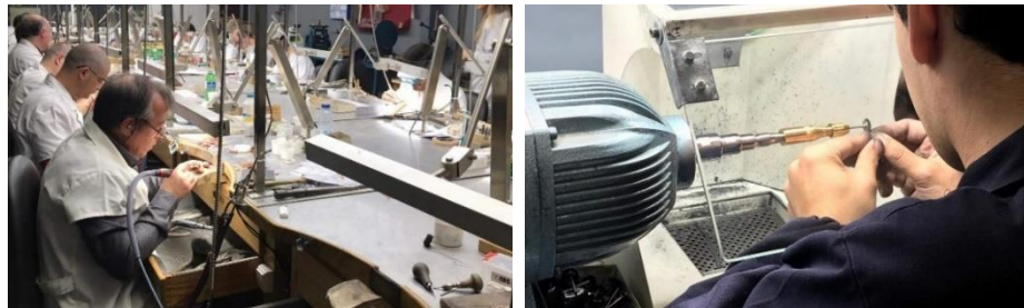
Figura 184 – Processo de apuramento (esquerda) e de polimento (direita).
