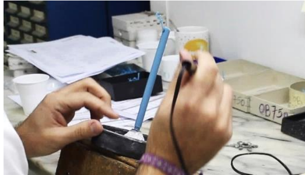
Figura 121 – Árvore de cera em construção na JCF.
