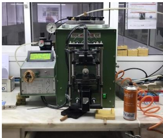
Figura 120 – Máquina de injeção de cera na JCF.
