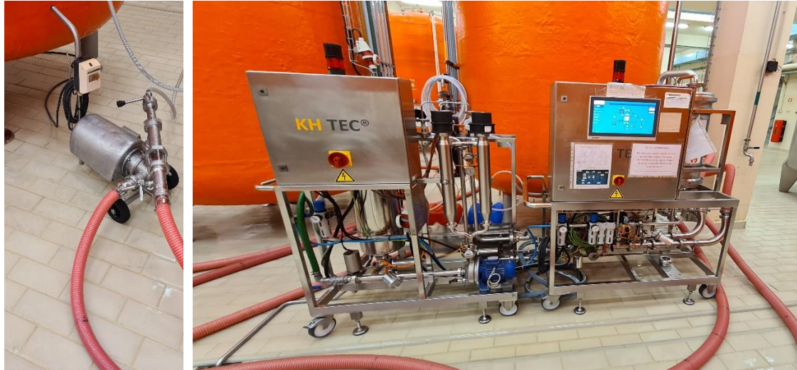
Figura 4. 2 – Sistema de carbonatação convencional e máquina de carbonatação, respetivamente.
