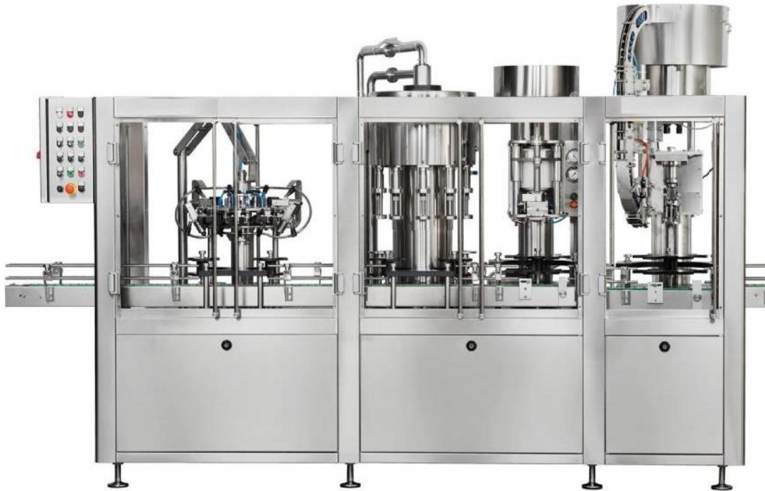
Figura 3. 2 – Exemplo de uma linha de engarrafamento, composta por uma enxaguadora, enchedora, rolhadora e capsuladora, respetivamente (UKSinc, s.d.).
