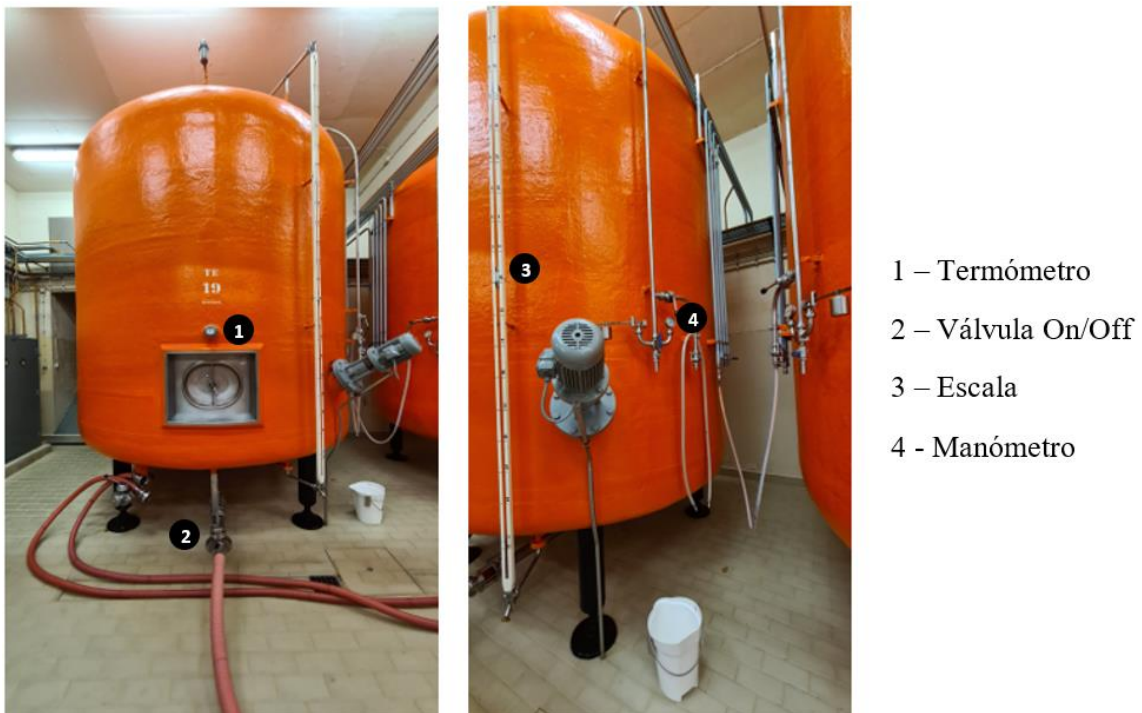
Figura 4. 1 – Exemplo de um tanque de enchimento com uma capacidade de 21000 L.
