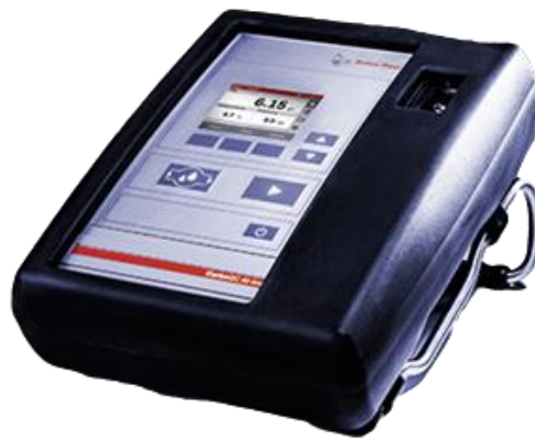
Figura 4. 3 – Medidor do conteúdo de dióxido de carbono de bebidas carbonatadas (CboxQC) (Adaptado de Anton Paar, s.d.).
