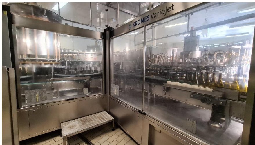
Figura 4. 11 – Enxaguadora, enchedora e rolhadora da linha de enchimento 3.
