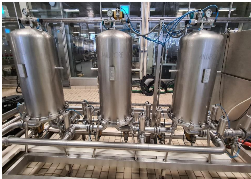
Figura 4. 9 – Filtros Millipore com uma capacidade individual de 143 L.
