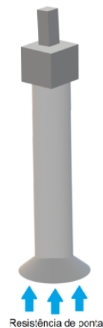
Figura 2.19 – Esquema de um tubulão (Cavagni Construtora, 2023).
