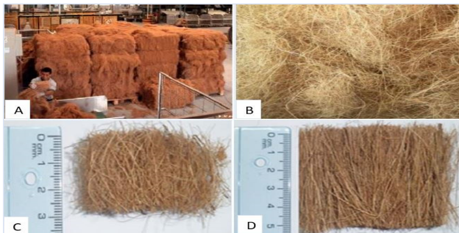
Figura 16. Fibras de coco utilizadas no estudo (A – fibras em fardo; B – fibras desfiadas; C – fibras cortadas com 25 mm de comprimento; D – fibras cortadas com 50 mm de comprimento)
