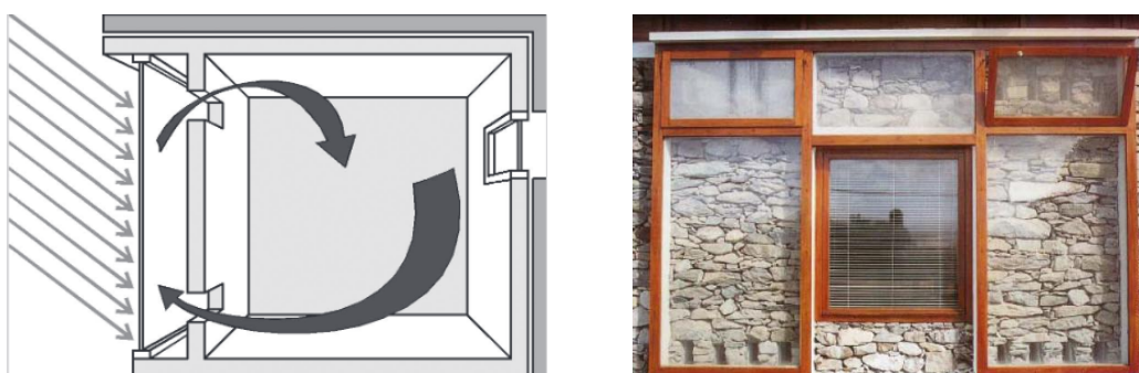
Casa Shäffer, Porto Santo (Com Paredes de Trombe) Arqº. Günther Ludewi
