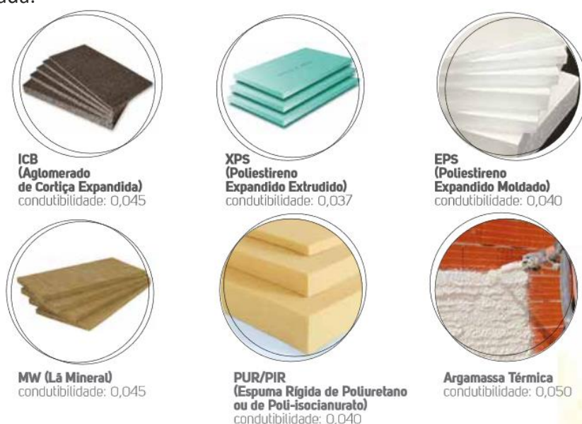
Figura 11 – Tipos de isolamento e respetivos valores de condutibilidade térmica, [W/(m.°C)] [48].
