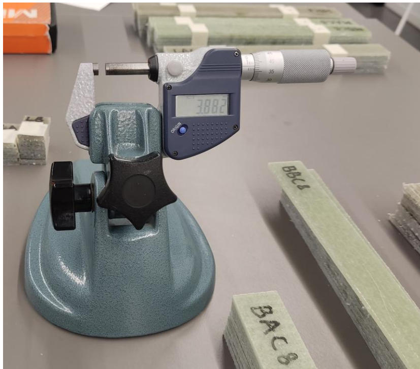
Figura 46 - Micrómetro utilizado na medição dos provetes
