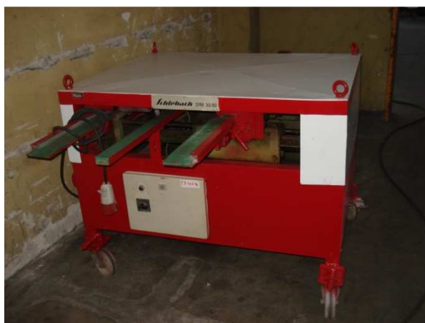
Figura 67 - Máquina de perfilagem das chapas de zinco
