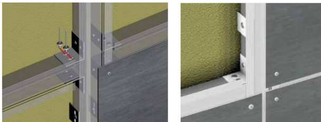
Figura 52 - Pormenor de montagem do sistema cravado/aparafusado [6]
