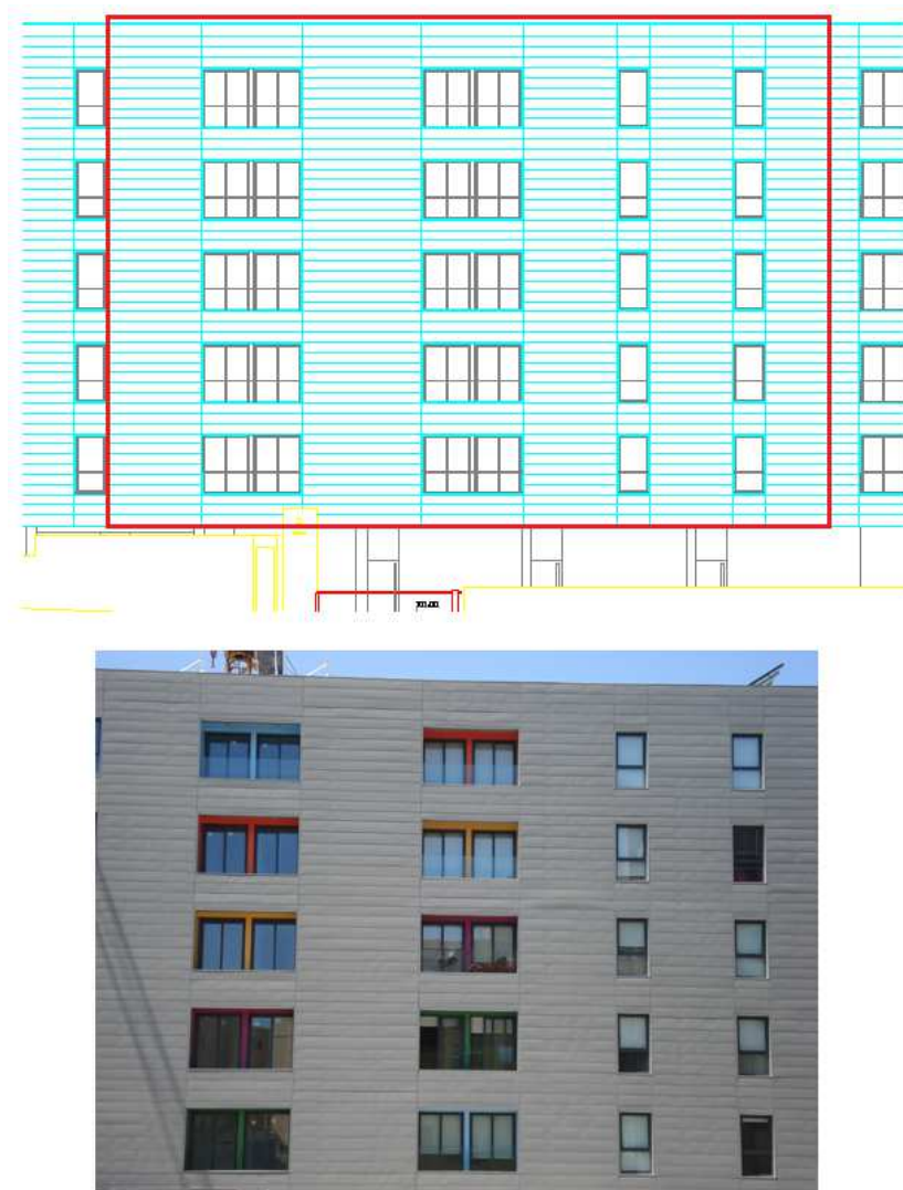
Figura 32 - Parte de projeto de estereotomia de uma fachada e a solução final
