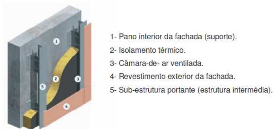
Figura 38 - Componentes de uma fachada ventilada [66]
