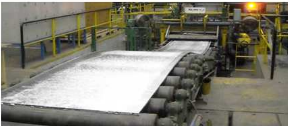
Figura 11 - Processo de laminagem do zinco [34]
