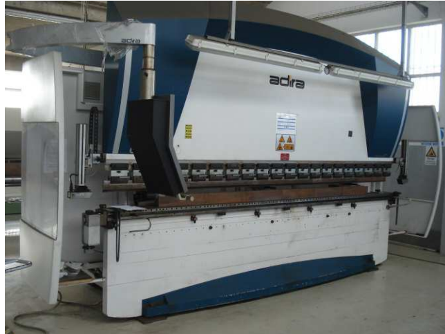
Figura 45 - Quinadeira (comprimento da chapa = 4m) (Fábrica da “VMZINC”)
