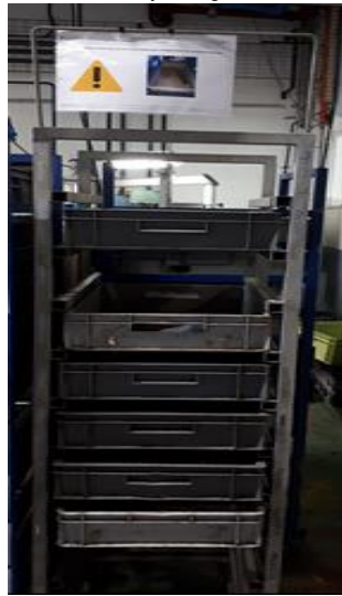
Figura 30 - Rack de reposições de linha
