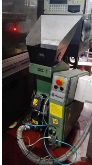
Figura 2 – Exemplo de um triturador localizado na central de reciclagem
