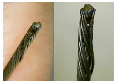
Figura 37 - Defeito no corte (cabo aberto)
