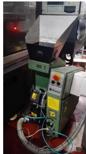
Figura 46 - Exemplo de um triturador localizado na central de reciclagem
