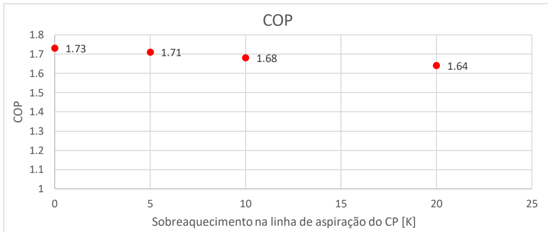
Figura 25 - Gráfico com a variação do COP com o aumento do sobreaquecimento na linha de aspiração da compressão paralela
