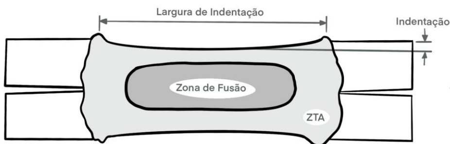
Figura 10 – Caracterização de uma indentação da superfície do ponto de soldadura. Adaptado de [37]
