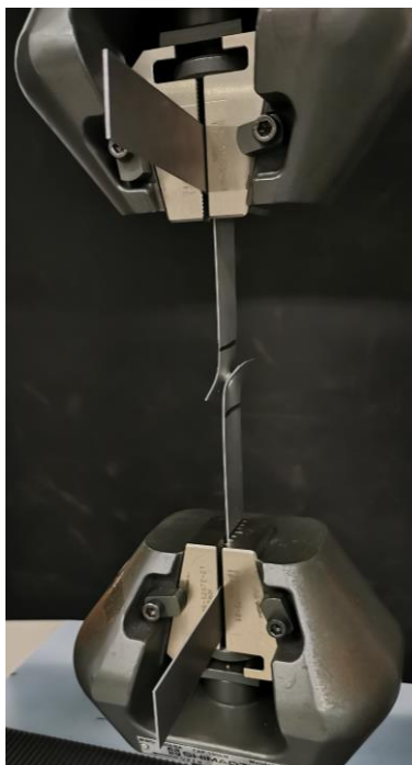
Figura 54 – Realização de um ensaio de corte a provetes fabricados por soldadura por pontos
