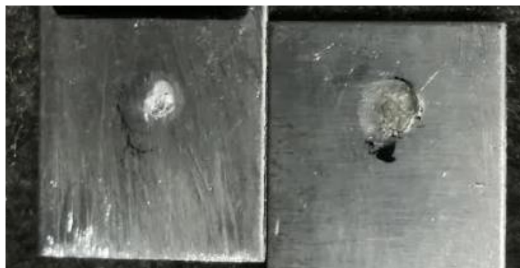
Figura 74 – Foto da rotura do ponto de soldadura proveniente do ensaio de corte no provete 5C fabricado em alumínio 1050 (zona interna – esquerda; zona externa – direita)
