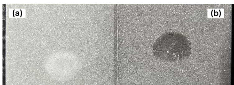
Figura 39 – Visualização da zona interna do ponto de soldadura (a) e do entalhe (b) após a quebra da ligação soldada nas chapas de alumínio que sofreram granalhagem
