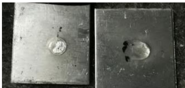
Figura 72 – Foto de rotura do ponto de soldadura proveniente do ensaio de corte no provete 1A fabricado em alumínio 1050 (zona interna – esquerda; zona externa – direita)
