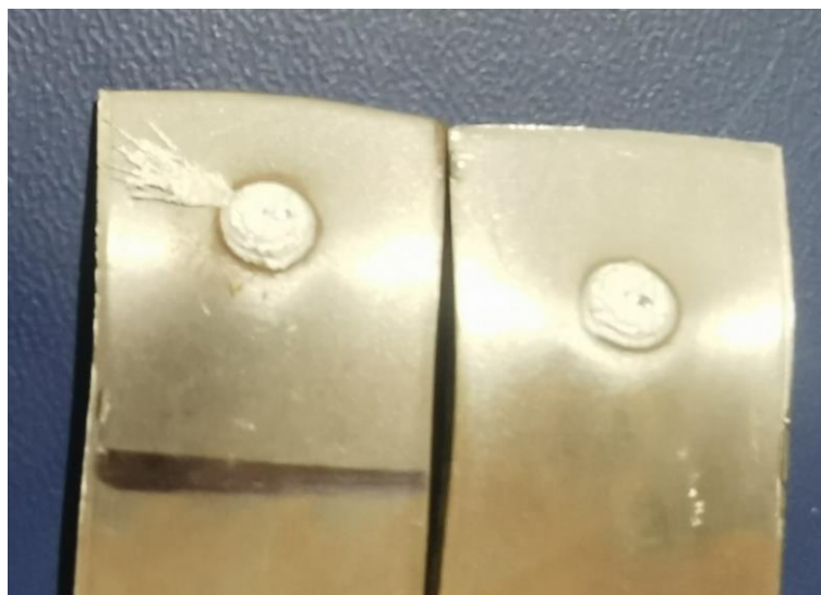
Figura 63 – Foto da rotura do ponto de soldadura proveniente do ensaio de corte no provete 7C fabricado em aço St12
