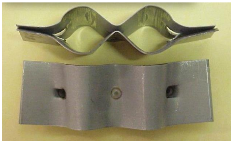
Figura 17 – Ensaio de “Chisel” realizado em laboratório com base em chapas de 1,4 mm de DP 3500/600. Adaptado de [55]
