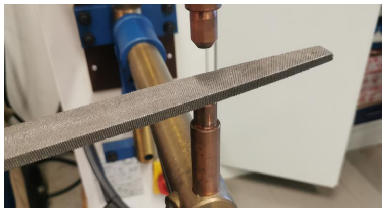
Figura 50 – Limagem dos elétrodos no equipamento de soldadura CEA NKLT 28
