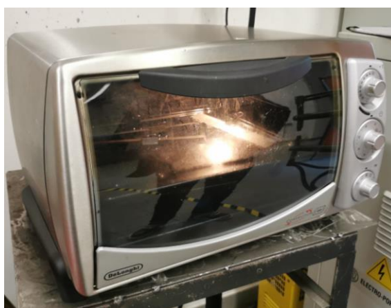
Figura 52 – Forno em utilização para a realização do pré-aquecimento dos provetes de alumínio 1050
