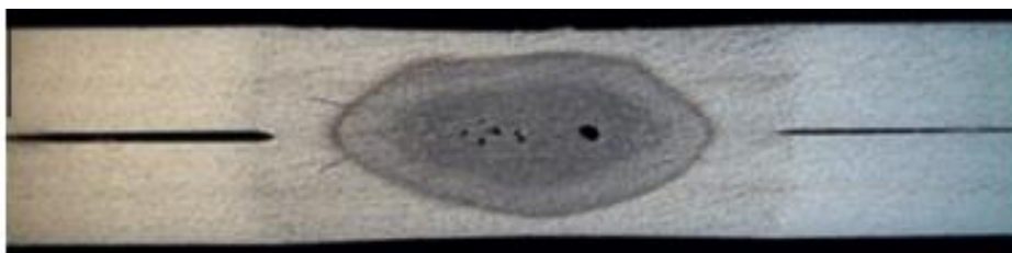
Figura 11 – Visualização do aparecimento de poros e fendas na zona interna do ponto de soldadura.
