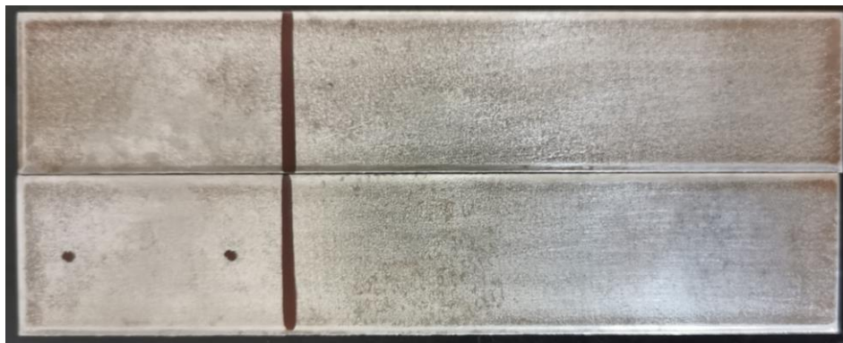
Figura 42 – Marcação dos pontos de soldadura e linhas de sobreposição nos provetes realizados com dois pontos de soldaduras
