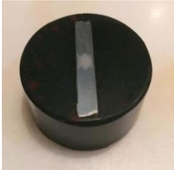
Figura 56 – Amostras embebidas em resina para posterior medição da microdureza
