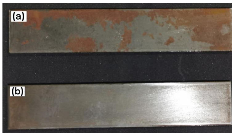
Figura 45 – Superfície das chapas de aço St12 antes (a) e após (b) a remoção dos óxidos com recurso a uma lixa de gramagem 500
