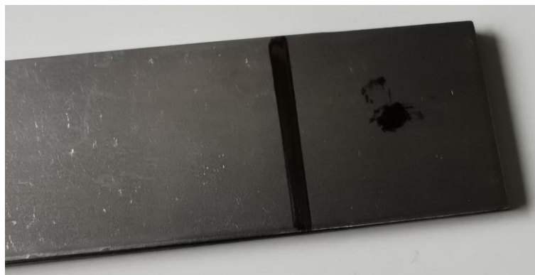
Figura 48 – Marcações realizadas nos provetes pré-soldadura com recurso ao espaçador fabricado
