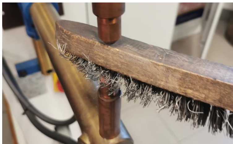
Figura 51 – Passagem da escova de aço nos elétrodos do equipamento de soldadura CEA NKLT 28
