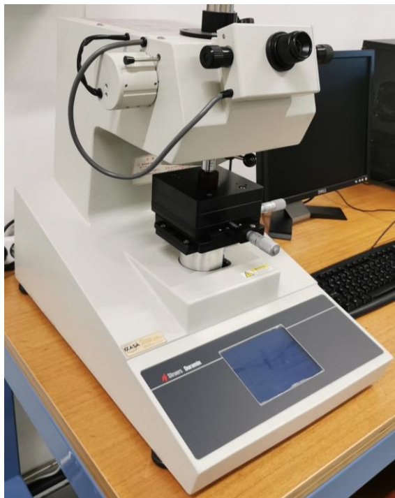
Figura 57 – Equipamento de medição das microdureza – Struers Duramin
