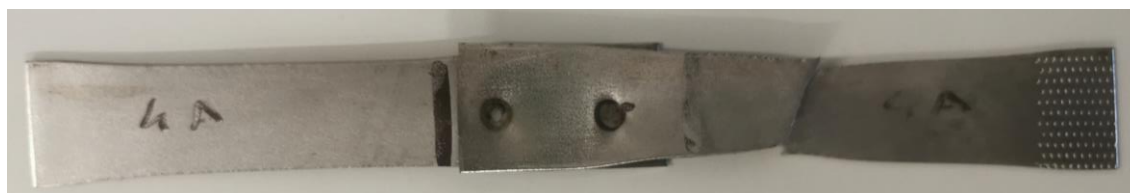
Figura 43 – Provetes de aço St12 realizado com base nos parâmetros de (4) do método de Taguchi após submetido ao ensaio de corte
