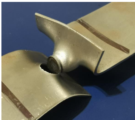
Figura 59 – Foto da rotura do ponto de soldadura proveniente do ensaio de corte no provete 1A fabricado em aço St12
