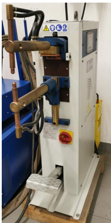
Figura 49 – Equipamento de soldadura CEA NKLT 28 em utilização para a soldadura dos provetes em aço
