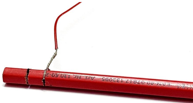
Fig. 5 – Detalhe da conexão do lápis ao circuito
