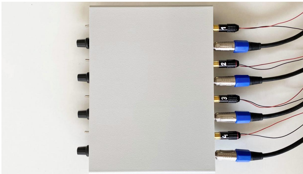
Fig. 12 – Ligação de cabos na caixa dos circuitos
