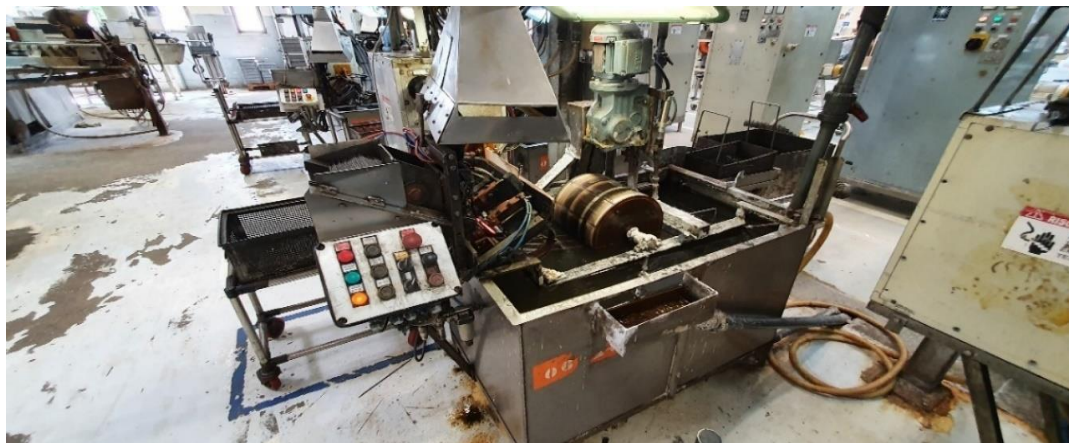
Figura 14 – Processo de Têmpera na SNA Europe.
