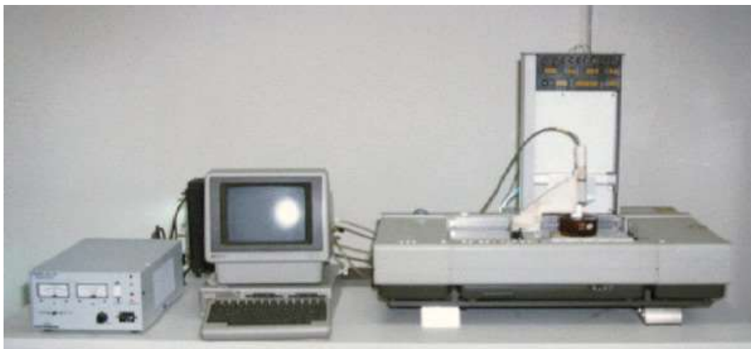
Figura 6 - “SLA-1”, a primeira impressora aditiva (Thefabricator, 2020)
