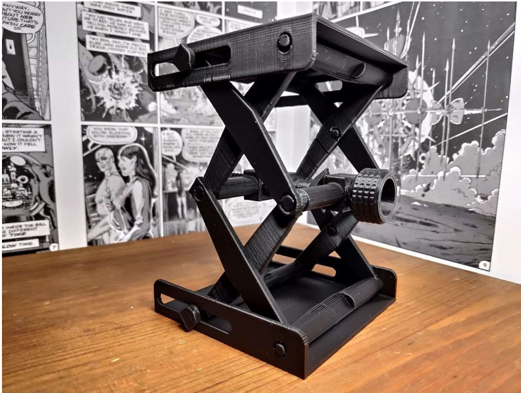
Figura 13 – Plataforma impressa sem necessidade de montagem (THINGVERSE, 2015)
