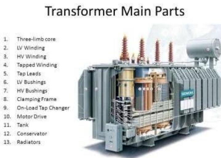
Figura 3 - Transformador com respetivos componentes identificados [27]
