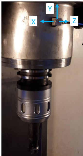
Figura 21 – Montagem do acelerómetro na árvore do centro de maquinagem CNC
