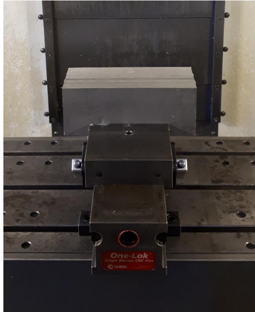
Figura 17 – Fixação do bloco no centro de maquinagem
