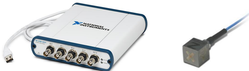
Figura 20 – Placa de aquisição e acelerómetro usados na recolha das vibrações.
