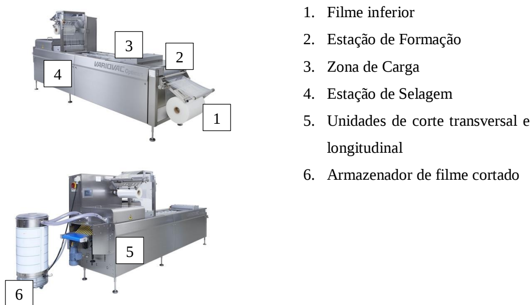
Figura 3.23- Termoformadora Variovac Optimus (Variovac, 2022).
