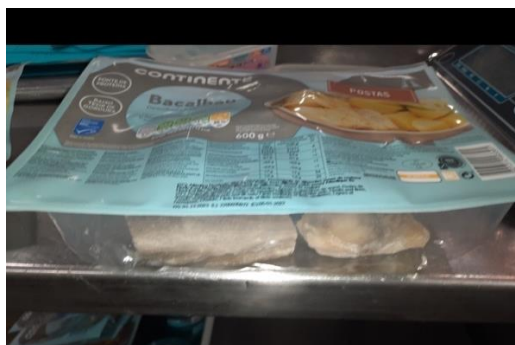
Figura 3.25- Embalagem em que o sistema de vácuo não funcionou.
