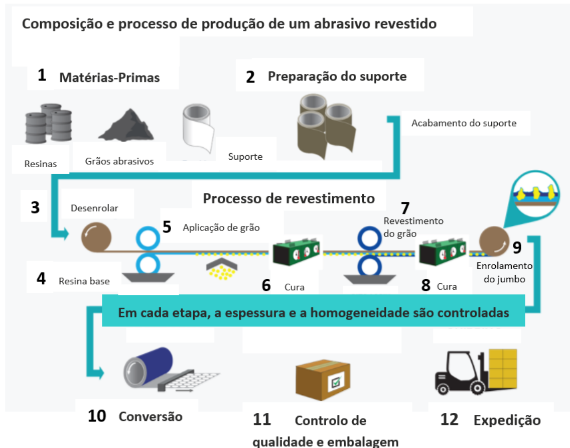
Figura 20 - Processo de produção de um abrasivo revestido. Adaptado de [23]
