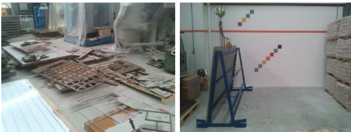
Figura 56 – Antes e depois da arrumação de retalhos de chapa no armazém 2
