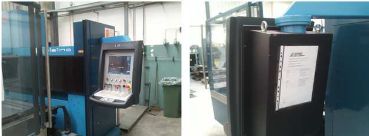
Figura 55 – Afixação da tabela com os bicos de corte a utilizar no processo de corte a laser
