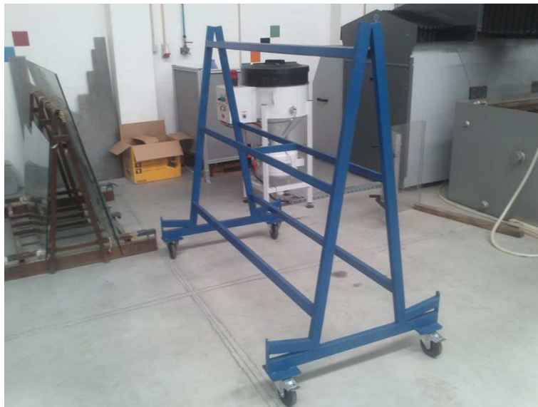
Figura 60 – Carrinho para movimentação de chapas
