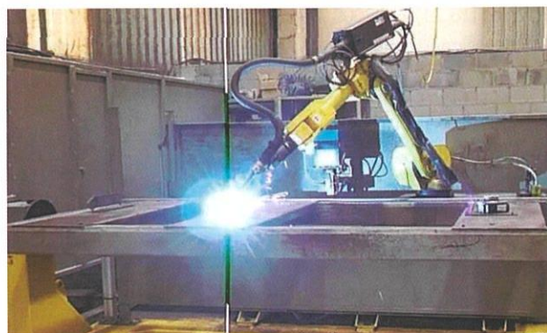
Figura 2. Ferramenta de soldadura montada na extremidade do sistema robótico.
