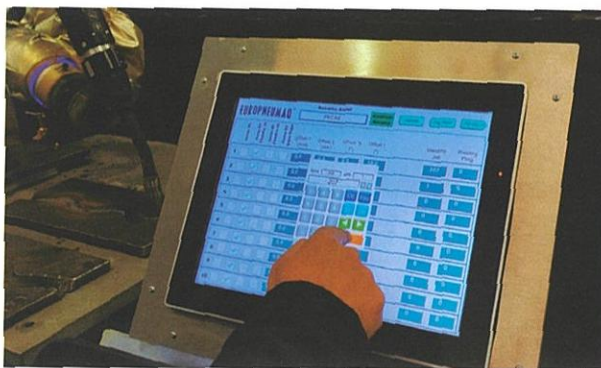
Figura 5. Edição das especificações de soldadura para os requisitos específicos de cada peça.
