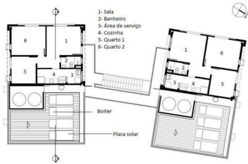
Figura 48 - Planta baixa do quarto pavimento (Fernandes, 2015)
